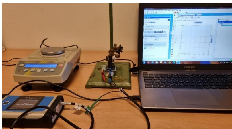
Slika 10. Aparatura za EIS mjerenje u dvoelektrodnom sustavu sa hidrogelom
