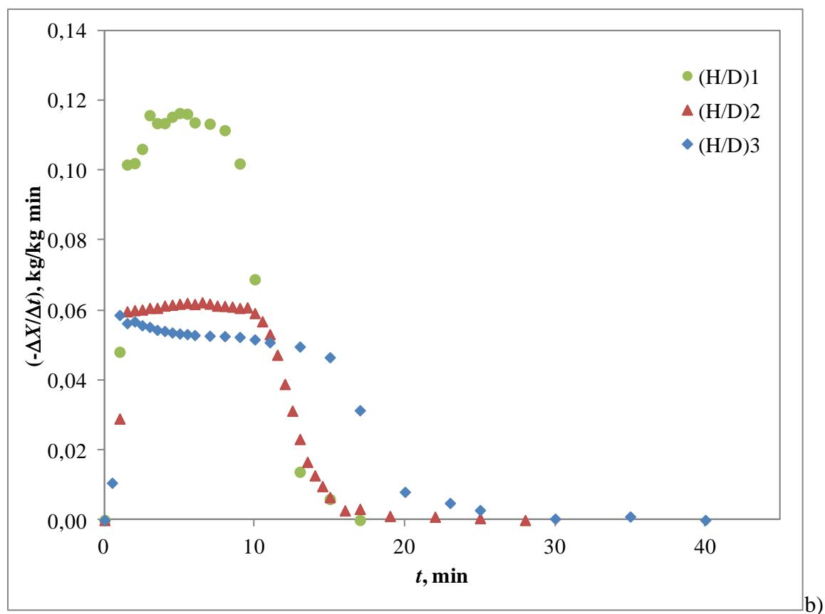
**Slika 29.** Utjecaj visine mirujućeg sloja čestica na kinetiku sušenja (uzorak 2;  $T=50 \text{ } ^\circ\text{C}$ ;
