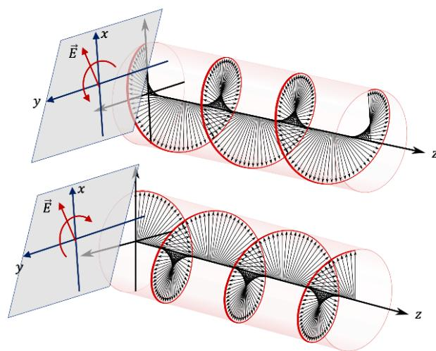
Slika 28. Desno i lijevo polarizirano svjetlo (47)
