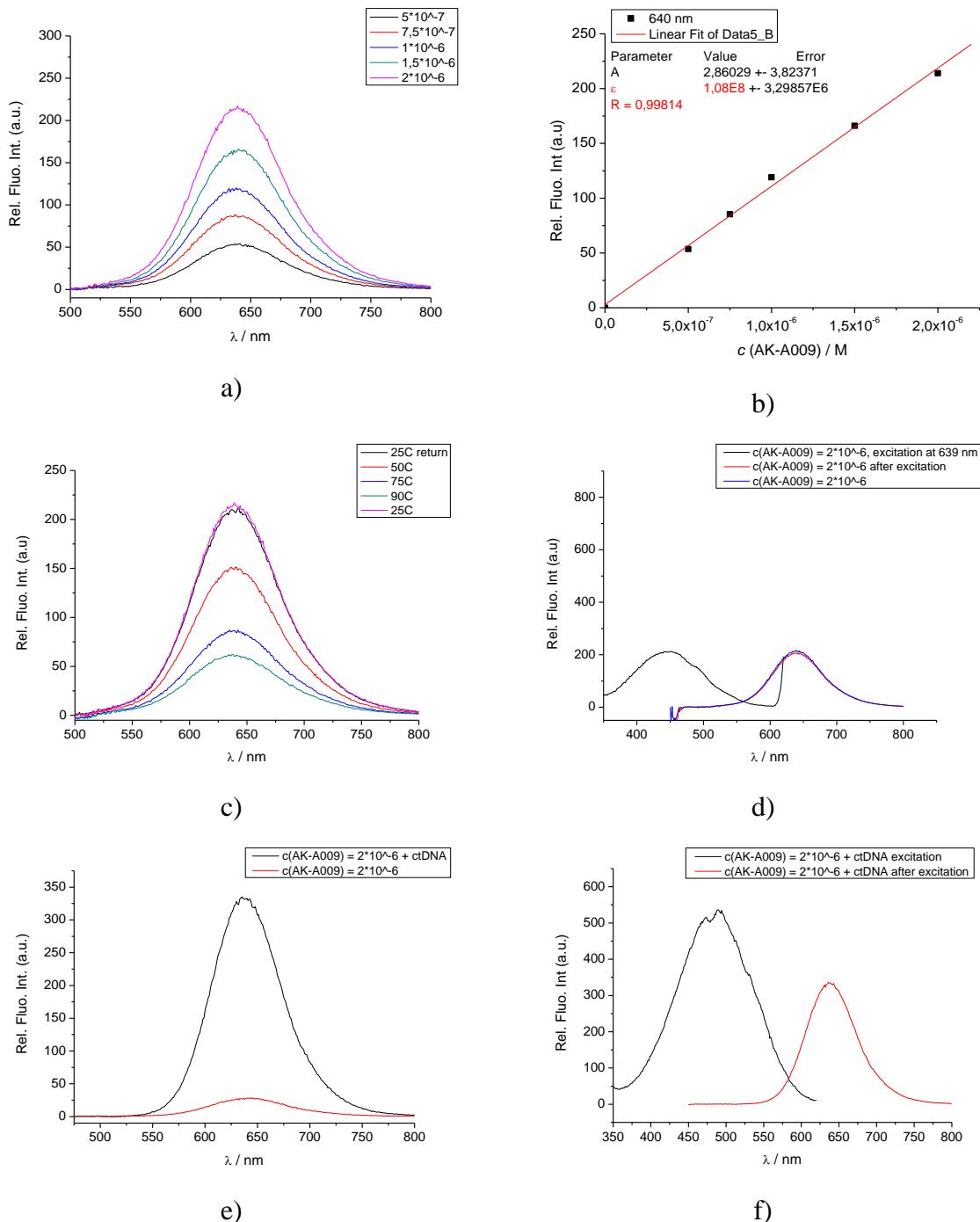
Slika 52. AK-A009: a) grafički prikaz ovisnosti relativnog intenziteta fluorescencije o koncentraciji pri ekscitacijskoj i emisijskoj pokutini od 20, 20 nm, b) dijagram maksimuma fluorimetrijskog intenziteta, c) temperaturni dijagram pri ekscitacijskoj i emisijskoj pokutini od 20, 20 nm, d) ekscitacijski spektar (20, 20 nm), e) usporedba relativnog intenziteta fluorescencije prije i nakon dodatka ctDNA (10, 10 nm), f) ekscitacijski spektar nakon dodatka ctDNA (10, 10 nm)
