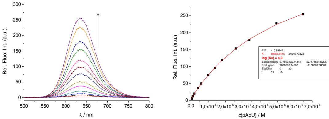
Slika 41. Ovisnost relativnog intenziteta fluorescencije o koncentraciji pApU za **AK-A009** pri ekscitacijskim i emisijskim pukotinama od 10 nm, 10 nm (lijevo) te određivanje konstante stabilnosti kompleksa RNA i male molekule **AK-A009** (desno)
