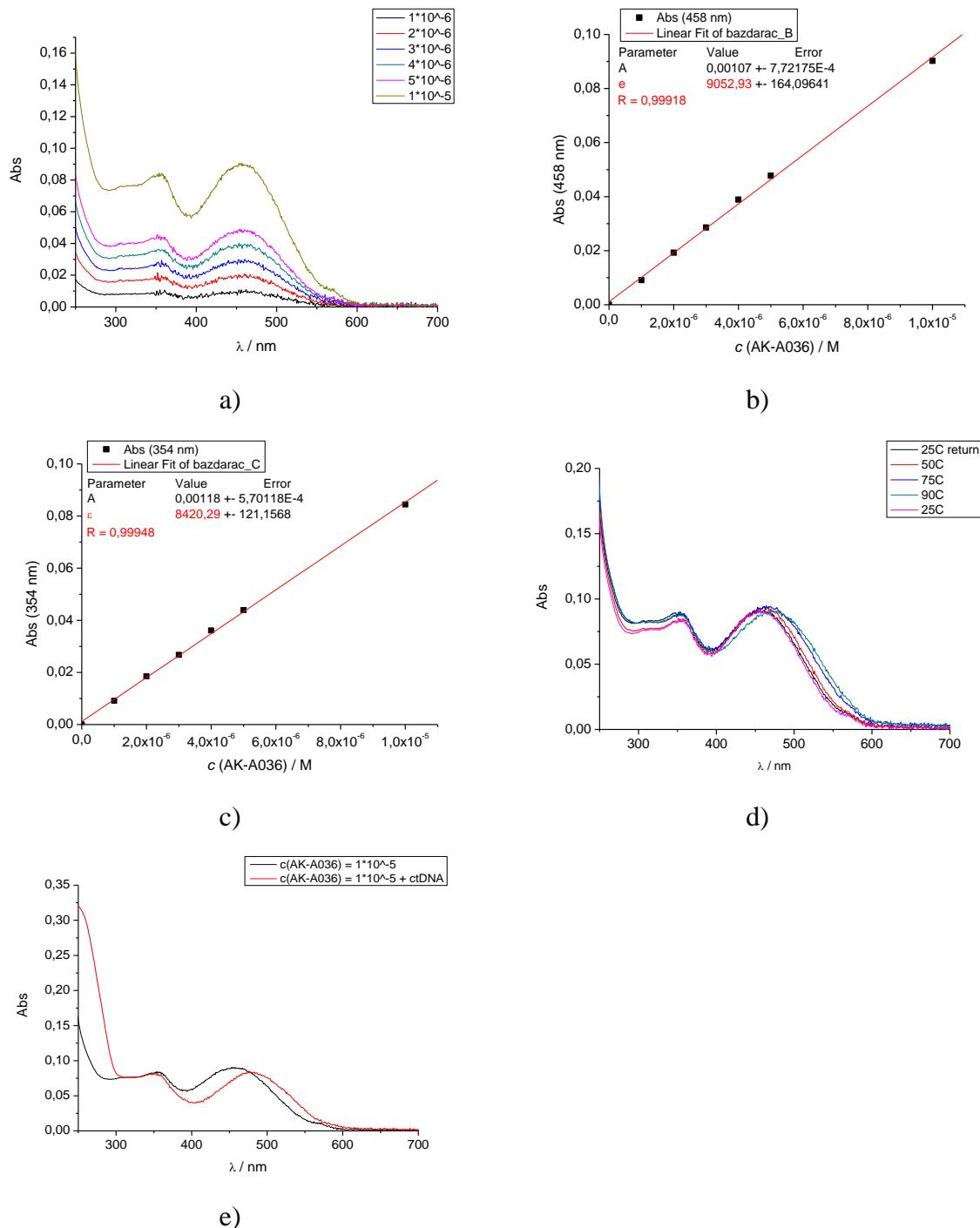
Slika 49. **AK-A036**: a) UV-Vis koncentracijski dijagram, b) dijagram maksimuma apsorbancije za 458 nm, c) dijagram maksimuma apsorbancije za 354 nm, d) temperaturni dijagram, e) prikaz razlike apsorbancije prije i poslije dodatka ctDNA u koncentraciji 5 puta većoj od spoja
