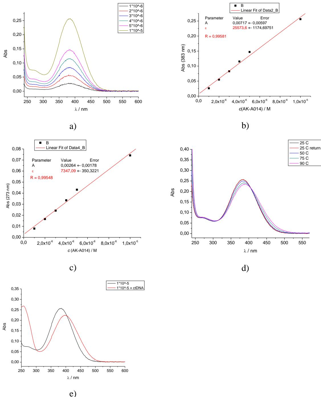
Slika 51. AK-A014: a) UV-Vis koncentracijski dijagram, b) dijagram maksimuma apsorbancije za 383 nm, c) dijagram maksimuma apsorbancije za 273 nm, d) temperaturni dijagram, e) prikaz razlike apsorbancije prije i poslije dodatka ctDNA u koncentraciji 5 puta većoj od spoja
