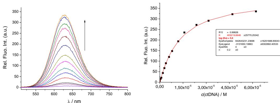
Slika 40. Ovisnost relativnog fluorimetrijskog intenziteta o koncentraciji pri titraciji s ctDNA za spoj **AK-A009** pri ekscitacijskim i emisijskim pukotinama od 10 nm, 10 nm (lijevo) i određivanje konstante stabilnosti kompleksa DNA i male molekule **AK-A009** (desno)
