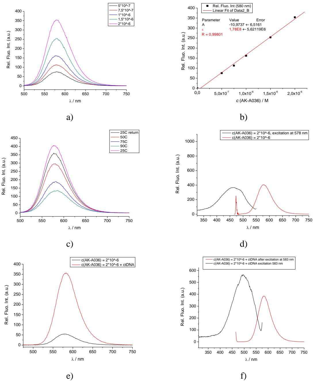
Slika 53. AK-A036: a) grafički prikaz ovisnosti relativnog intenziteta fluorescencije o koncentraciji pri ekscitacijskoj i emisijskoj pukotini od 20, 20 nm, b) dijagram maksimuma fluorimetrijskog intenziteta, c) temperaturni dijagram pri ekscitacijskoj i emisijskoj pukotini od 20 20 nm, d) ekscitacijski spektar (20, 20 nm), e) usporedba relativnog intenziteta fluorescencije prije i nakon dodatka ctDNA (10, 10 nm), f) ekscitacijski spektar nakon dodatka ctDNA (10, 10 nm)
