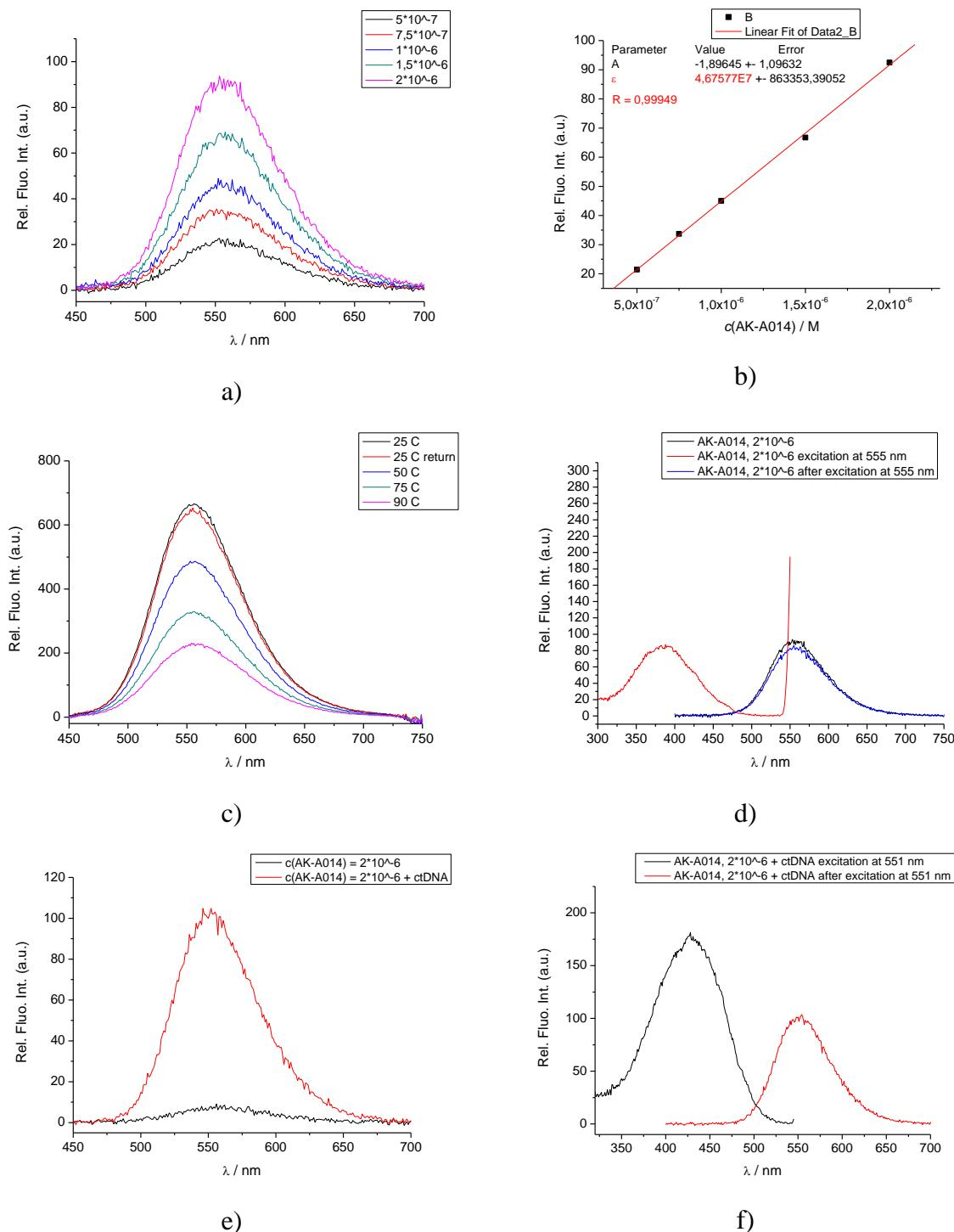
Slika 55. AK-A014: a) grafički prikaz ovisnosti relativnog intenziteta fluorescencije o koncentraciji pri ekscitacijskoj i emisijskoj pokutini od 10, 10 nm, b) dijagram maksimuma fluorimetrijskog intenziteta, c) temperaturni dijagram pri ekscitacijskoj i emisijskoj pokutini od 20, 20 nm, d) ekscitacijski spektar (10, 10 nm), e) usporedba relativnog intenziteta fluorescencije prije i nakon dodatka ctDNA (5, 5 nm), f) ekscitacijski spektar nakon dodatka ctDNA (5, 5 nm)
