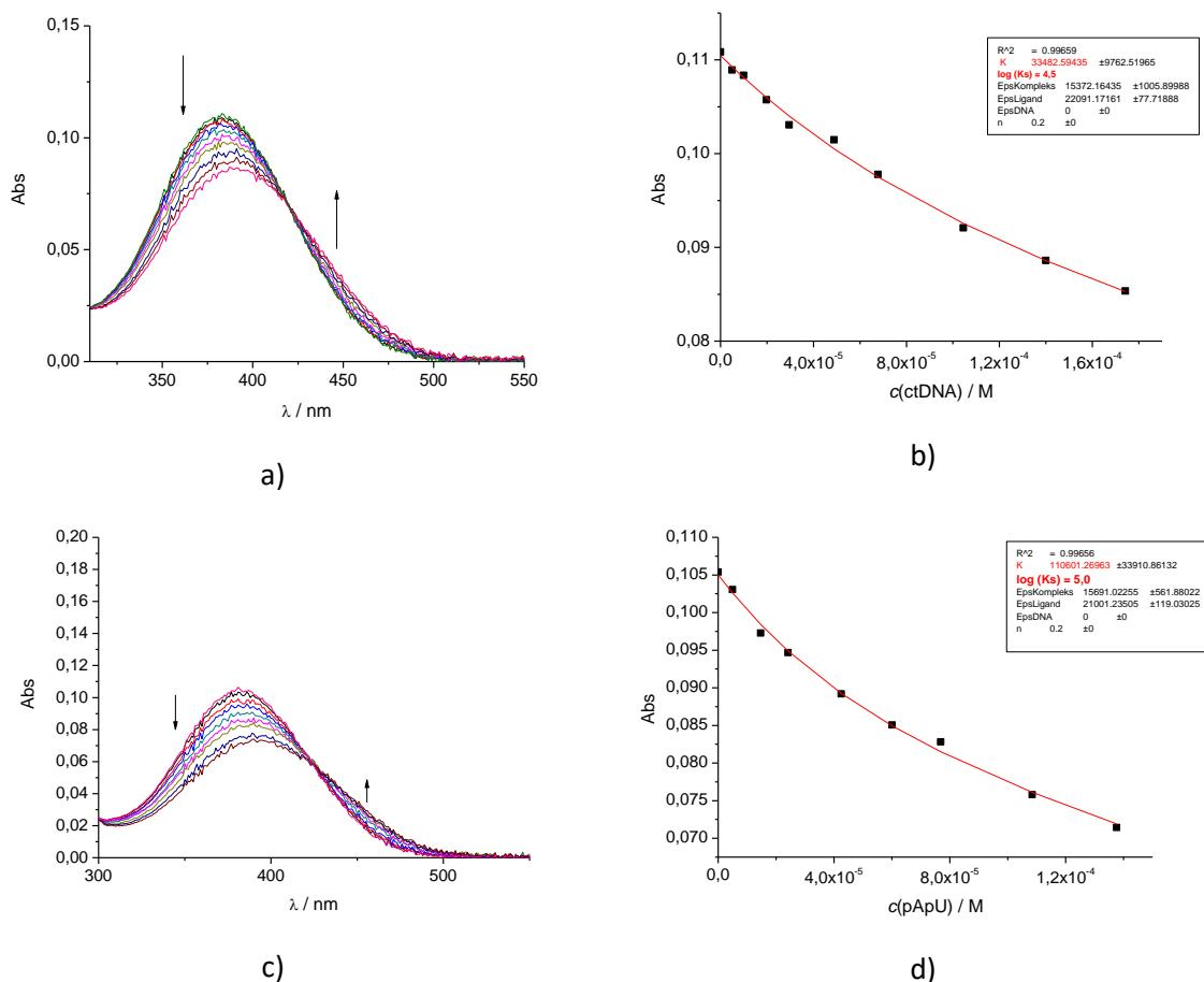
Slika 57. **AK-A014:** a) ovisnost apsorbancije o koncentraciji pri titraciji spoja s ctDNA, b) određivanje konstante stabilnosti kompleksa DNA i male molekule putem Scatchardove jednadžbe, c) ovisnost apsorbancije o koncentraciji pri titraciji spoja s pApU, d) određivanje konstante stabilnosti kompleksa RNA i male molekule putem Scatchardove jednadžbe
