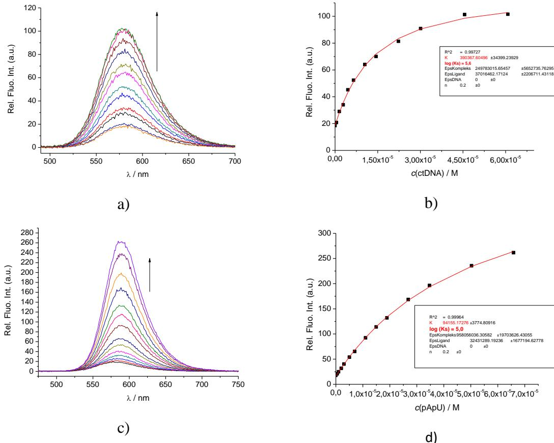
Slika 58. **AK-A036:** a) ovisnost relativnog fluorimetrijskog intenziteta o koncentraciji pri titraciji s ctDNA, b) određivanje konstante stabilnosti kompleksa DNA i male molekule putem Scatchardove jednadžbe, c) ovisnost relativnog fluorimetrijskog intenziteta o koncentraciji pri titraciji s pApU d) određivanje konstante stabilnosti kompleksa RNA i male molekule putem Scatchardove jednadžbe pri titracijama sa pApU
