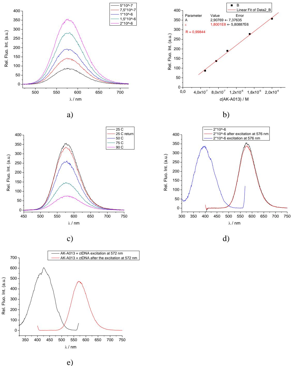
Slika 54. AK-A013: a) grafički prikaz ovisnosti relativnog intenziteta fluorescencije o koncentraciji pri ekscitacijskoj i emisijskoj pokutini od 10, 10 nm, b) dijagram maksimuma fluorimetrijskog intenziteta, c) temperaturni dijagram pri ekscitacijskoj i emisijskoj pukotini od 10, 10 nm, d) ekscitacijski spektar (10, 10 nm), e) ekscitacijski spektar nakon dodatka ctDNA (10, 5 nm)
