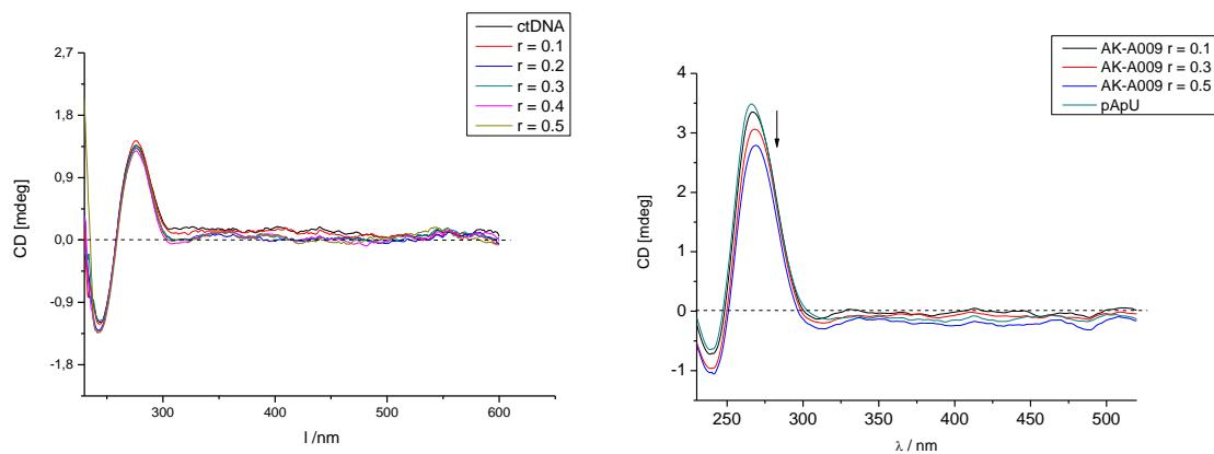
Slika 47. Ovisnost cirkularnog dikroizma o promjeni omjera spoja i polinukleotida, gdje slike lijevo prikazuju spekture za ctDNA, dok desno za pApU
