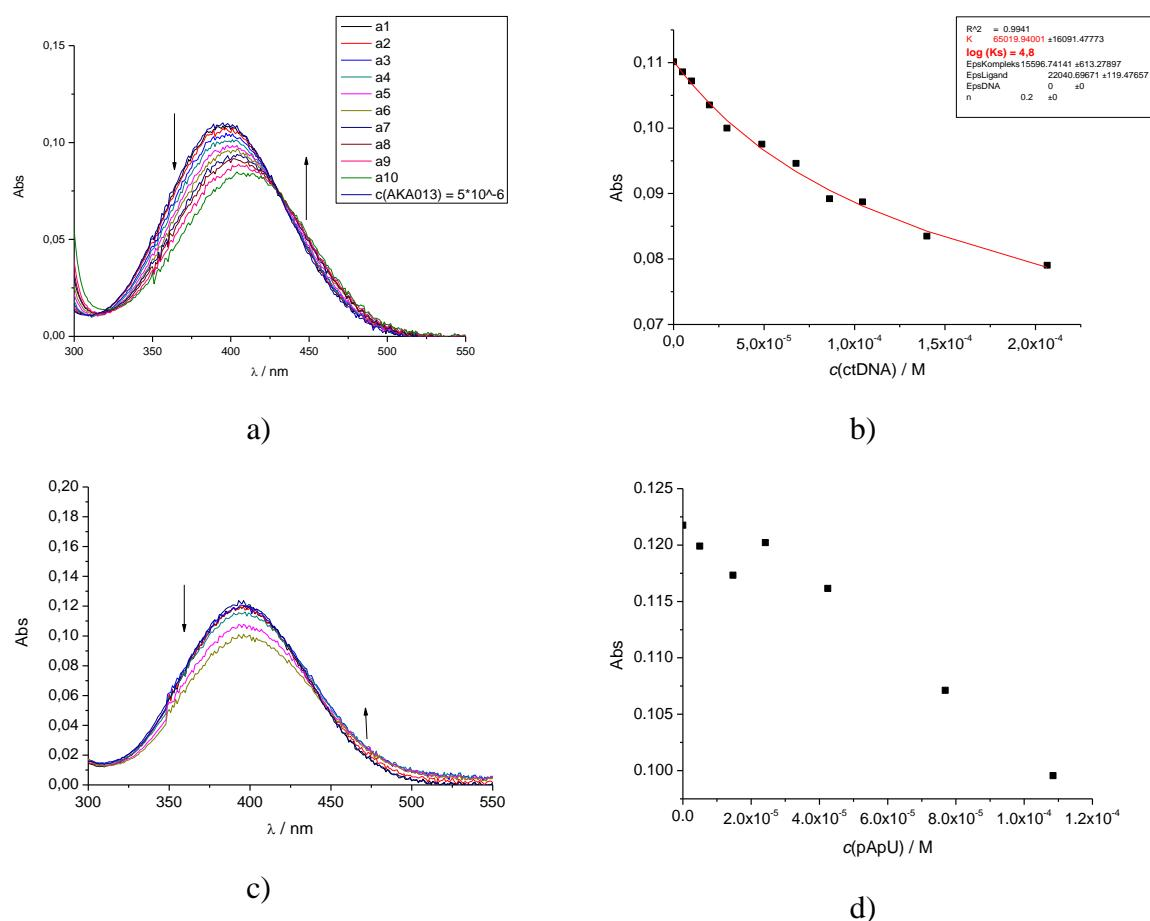
Slika 56. AK-A013: a) ovisnost apsorbancije o koncentraciji pri titraciji spoja s ctDNA, b) određivanje konstante stabilnosti kompleksa DNA i male molekule putem Scatchardove jednadžbe, c) ovisnost apsorbancije o koncentraciji pri titraciji spoja s pApU, d) određivanje konstante stabilnosti kompleksa RNA i male molekule putem Scatchardove jednadžbe
