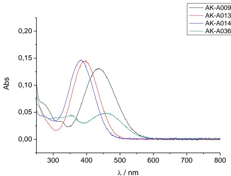
Slika 32. Usporedba apsorbancije za sve spojeve pri istoj koncentraciji
