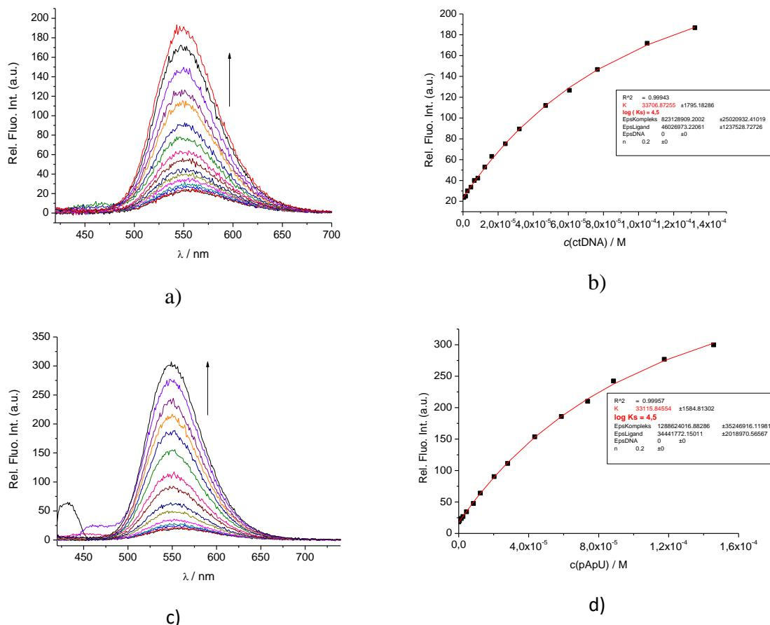
Slika 60. **AK-A014:** a) ovisnost relativnog fluorimetrijskog intenziteta o koncentraciji pri titraciji s ctDNA, b) određivanje konstante stabilnosti kompleksa DNA i male molekule putem Scatchardove jednadžbe, c) ovisnost relativnog fluorimetrijskog intenziteta o koncentraciji pri titraciji s pApU, d) određivanje konstante stabilnosti kompleksa RNA i male molekule putem Scatchardove jednadžbe pri titracijama sa pApU
