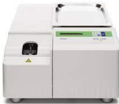
Slika 3.3.2.1. Diferencijalni pretražni kalorimetar, Mettler Toledo DSC 823e
