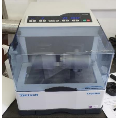
Slika 3.2.2.1. Kriogeni mlin s bubnjem, Retsch CryoMill
