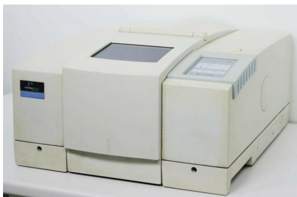
Slika 3.3.1.1. FTIR spektrofotometar PerkinElmer Spectrum One
