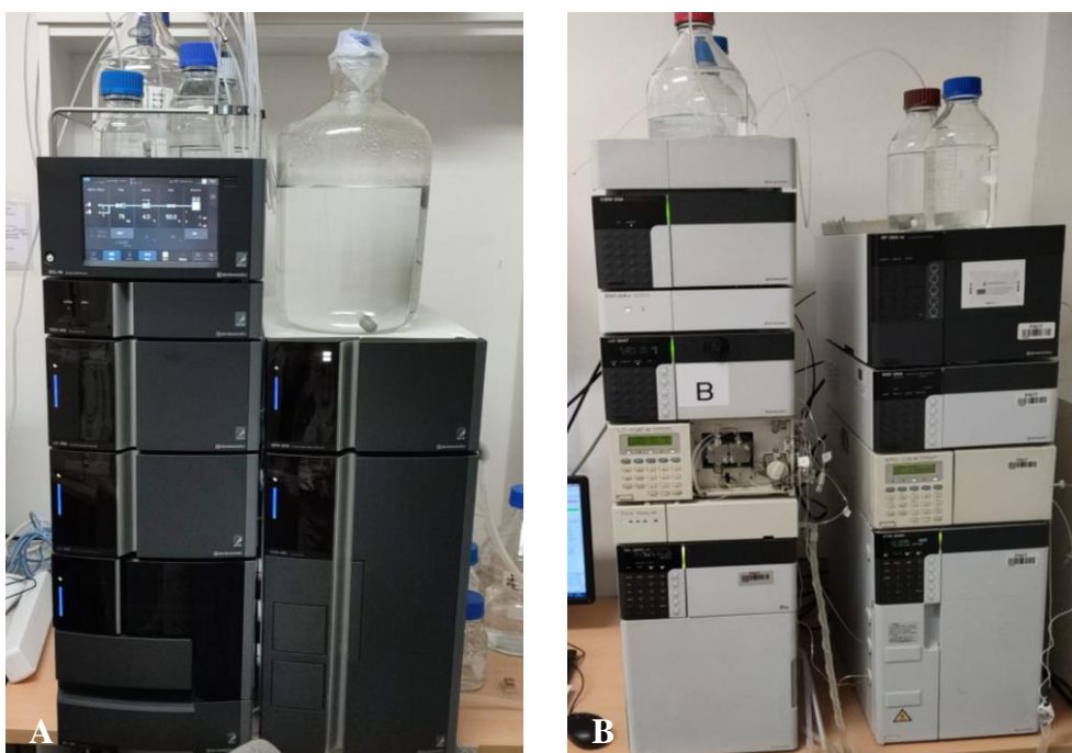
SLIKA 3.3. A: HPLC opremljen PDA detektorom i B: HPLC s UV detektorom
