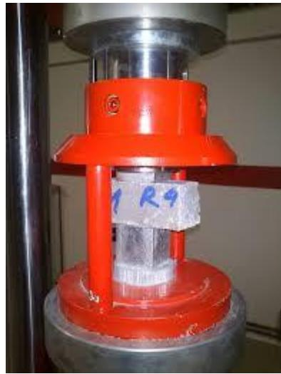
**Slika 8.** Hidraulična preša i uzorak betona<sup>33</sup>
