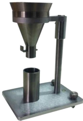
Slika 10. Aparatura za mjerjenje volumne mase cementa<sup>34</sup>
