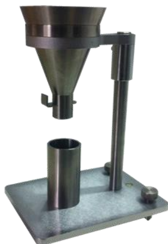
Slika 10. Aparatura za mjerenje volumne mase cementa 34
