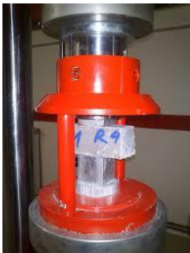
Slika 8. Hidraulična preša i uzorak betona 33
