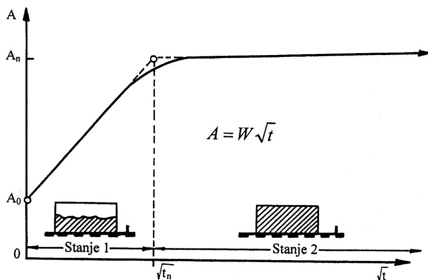
Slika 9. Prikaz mjerenja vodoupojnosti.
