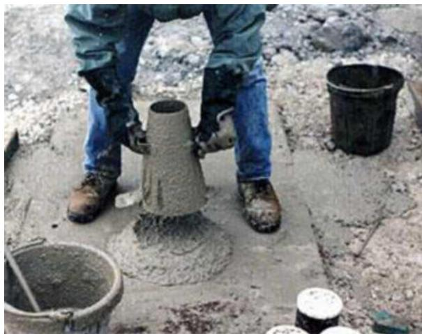
**Slika 7.** Test razljevanja<sup>32</sup>
