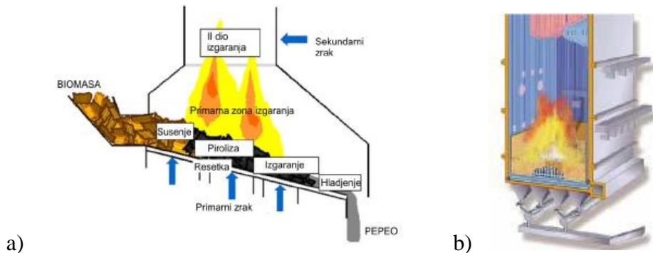
Slika 2. Prikaz izgaranja biomase u a) ložištima s pomičnom rešetkom i b) mjehurićastom fluidiziranim sloju<sup>9</sup>
