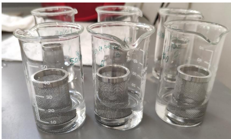
Slika 15. Test bubrenja za isprintane tablete
