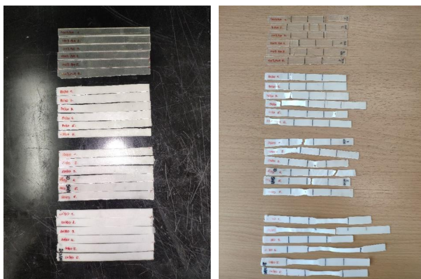
Slika 26. Epruvete prije i nakon vlačnog ispitivanja
