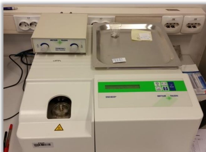
Slika 14. Fotografija diferencijalnog pretražnog kalorimetra Mettler Toledo 822 (Mettler Toledo GmbH, Griefensee, Švicarska)
