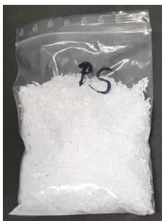
Slika 3.1. Granulirana plastika PS bez aditiva koja se koristila za dobivanje MP-e
