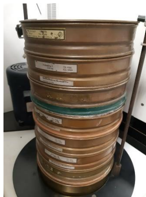
Slika 3.7. Mehaničko sito korišteno za dobivanje MP-a određene raspodjele veličine čestica
