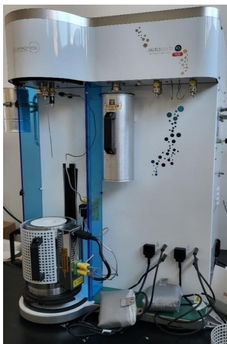
Slika 33. Quantachrome Autosorb uređaj za mjerenje specifične površine i poroznosti
