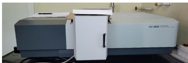
Slika 32. Shimadzu UV/VIS/NIR spektrometar, model UV-3600 dostupan u Zavodu za kemiju materijala, Instituta Ruđer Bošković
