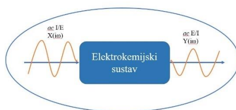
Slika 13. Shematski prikaz mjerenja elektrokemijske impedancijske spektroskopije, EIS
