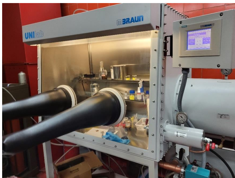
Slika 27. Komora s rukavicama (eng. glovebox ) Mbraun Unilab 4053 A
