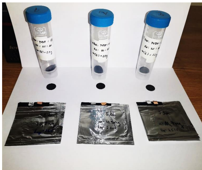
Slika 25. Pripremljene elektrode S1, S2 i S3 i pripadajući „coffee bag“ galvanski članci
