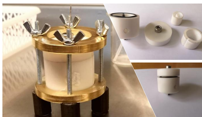
Slika 26. Dvoelektrodna ćelija za elektrokemijska ispitivanja dizajnirana u Laboratoriju za molekulska fiziku i sinteze novih materijala, Instituta Ruđer Bošković
