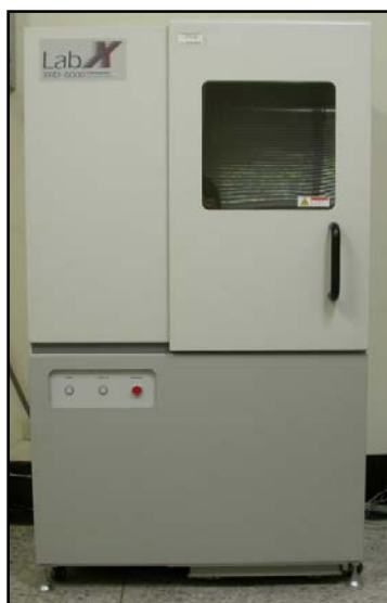
Slika 3.7. Uređaj za rendgensku difrakcijsku analizu, Shimadzu XRD-6000
