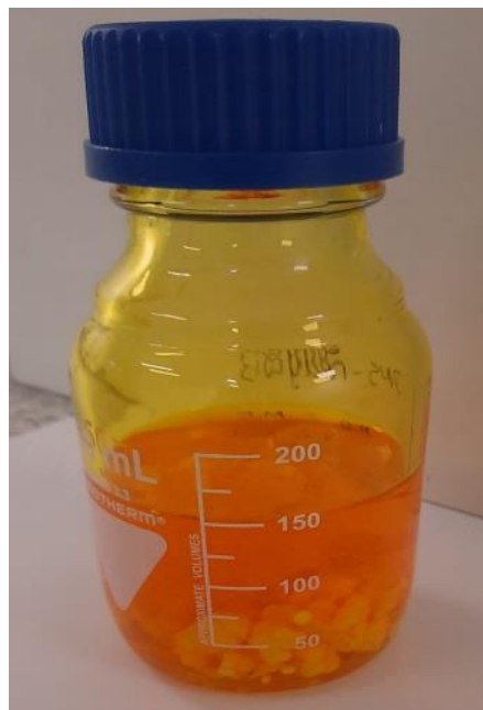
Slika 5. Kristali nastali u DNS reagensu tijekom čuvanja na temperaturi 4 °C
