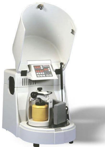
Slika 7. Laboratorijski planetarni mlin Fritsch Pulverisette 6
