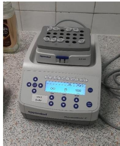
*Slika 3.1.* Tresilica Eppendorf ThermoMixer C (Eppendorf, Njemačka)
