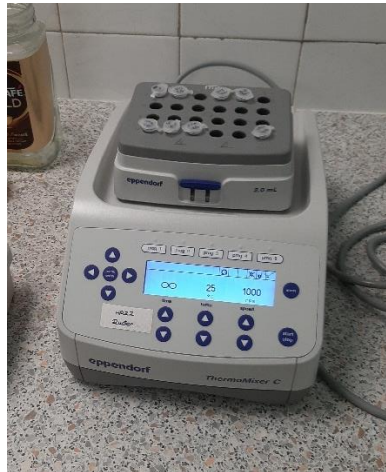
Slika 3.1. Tresilica Eppendorf ThermoMixer C (Eppendorf, Njemačka)
