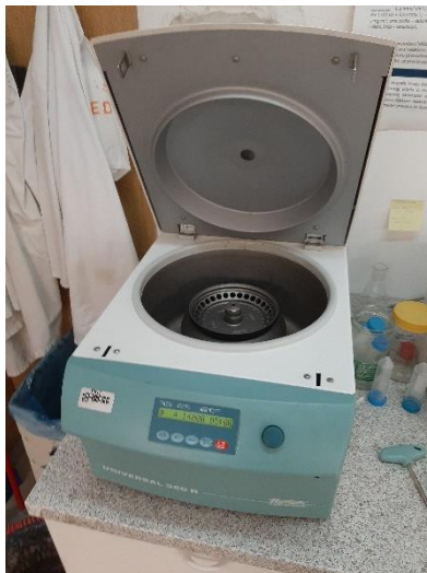
Slika 3.3. Centrifuga Universal 320/320R (Hettich, Njemačka)
