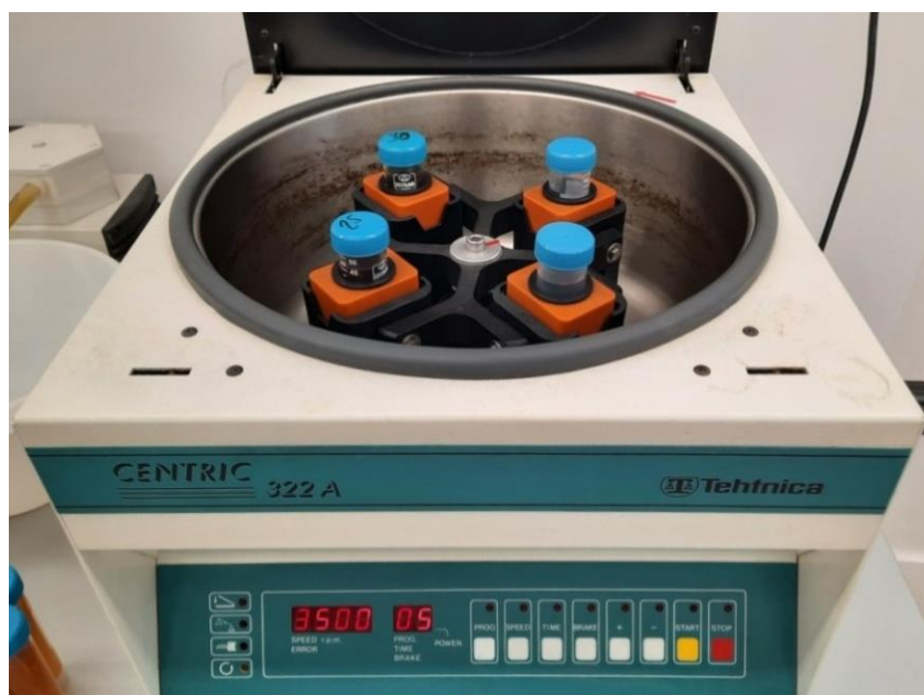
Slika 19. Prikaz kiveta stavljenih u centrifugu Tehnica Centric 322A
