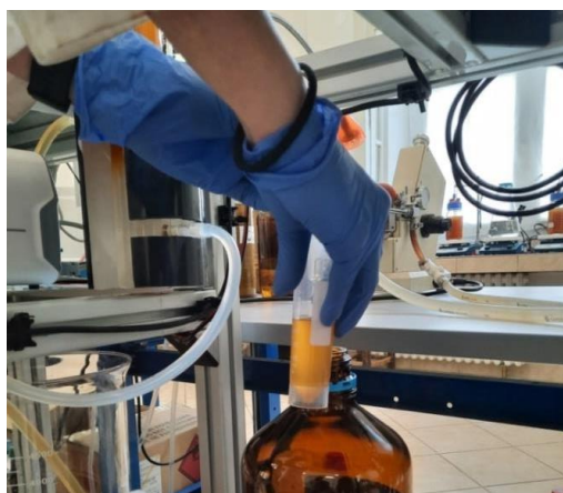
Slika 18. Punjenje kiveta pročišćenim uljem iz Karrove kolone
