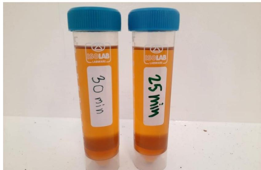
**Slika 20.** Kivete nakon centrifugiranja
