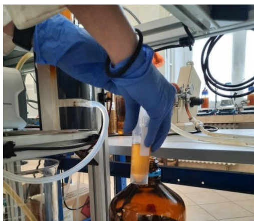
Slika 18. Punjenje kiveta pročišćenim uljem iz Karrove kolone
