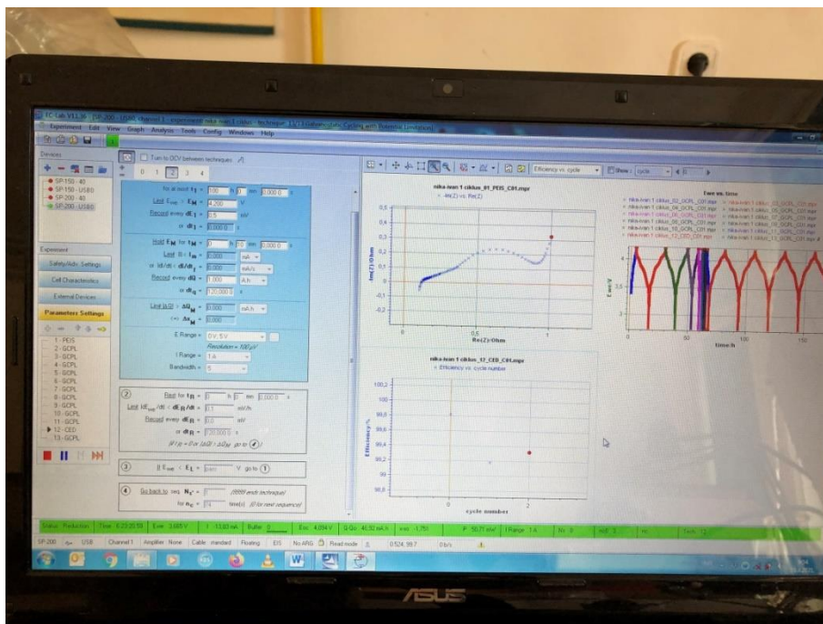
Slika 3.3. Program koji snima krivulje kao odzive elektrokemijskih metoda.
