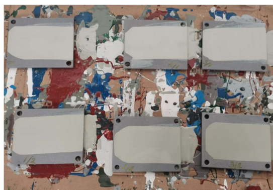
Slika 3.4 a) Pločice s nanesenim slojem premaza Hempaprime Multi 500 i b) pločice s nanesenim slojem premaza Hempadur Mastic 4588W
