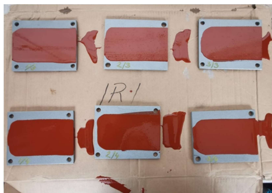
Slika 3.4 a) Pločice s nanesenim slojem premaza Hempaprime Multi 500 i b) pločice s nanesenim slojem premaza Hempadur Mastic 4588W
