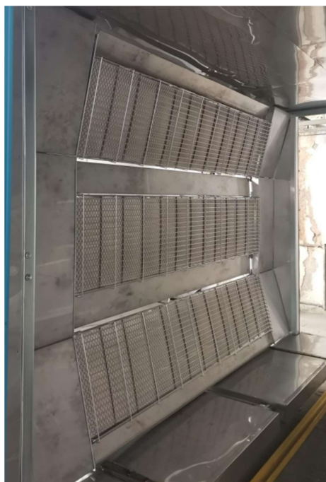
Slika 3.6 Peć s infracrvenim grijačima
