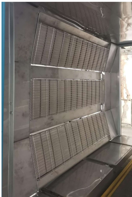
Slika 3.6 Peć s infracrvenim grijačima
