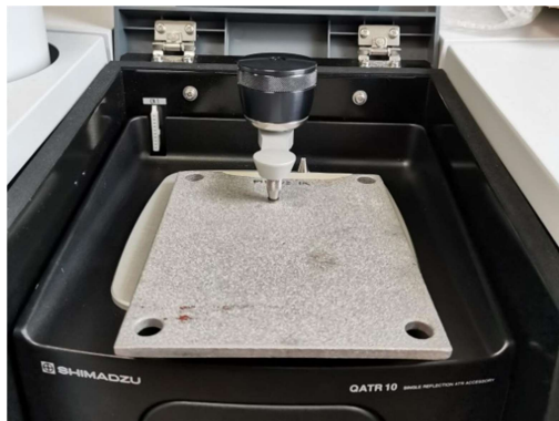
Slika 3.8 Prikaz položaja pločice s uzorkom u FTIR-ATR uređaju
