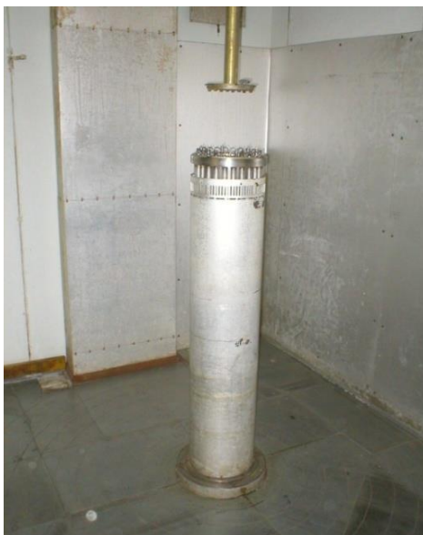
Slika 9. Izvor \gamma -zračenja, ^{60}\text{Co} , na Zavodu za kemiju materijala na Institutu „Ruđer Bošković“.
