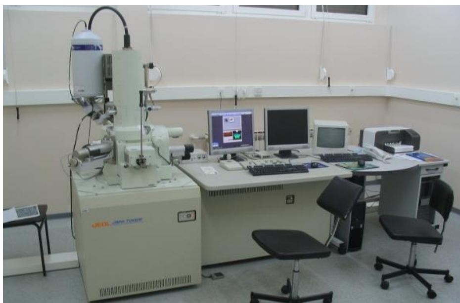
Slika 7. Pretražni elektronski mikroskop FESEM model JSM-7000F na Zavodu za kemiju materijala (IRB)
