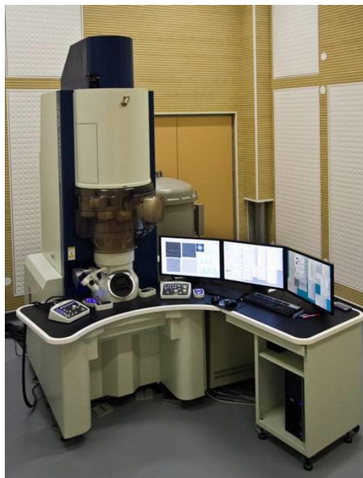
Slika 8. Transmisijski elektronski mikroskop atomske rezolucije, ARM 200 CF, JEOL, korišten za mikrostrukturnu karakterizaciju uzoraka u ovom radu. Uređaj se nalazi na Kemijskom institutu u Ljubljani.
