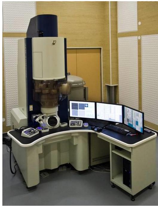
**Slika 8.** Transmisijski elektronski mikroskop atomske rezolucije, ARM 200 CF, JEOL, korišten za mikrostrukturnu karakterizaciju uzoraka u ovom radu. Uredaj se nalazi na Kemijskom institutu u Ljubljani.
