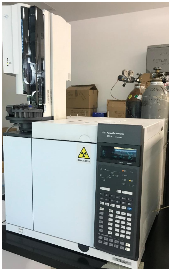
Slika 10. Plinski kromatograf (7890B, Agilent) s dvije kolone i dva detektora zahvata elektrona
