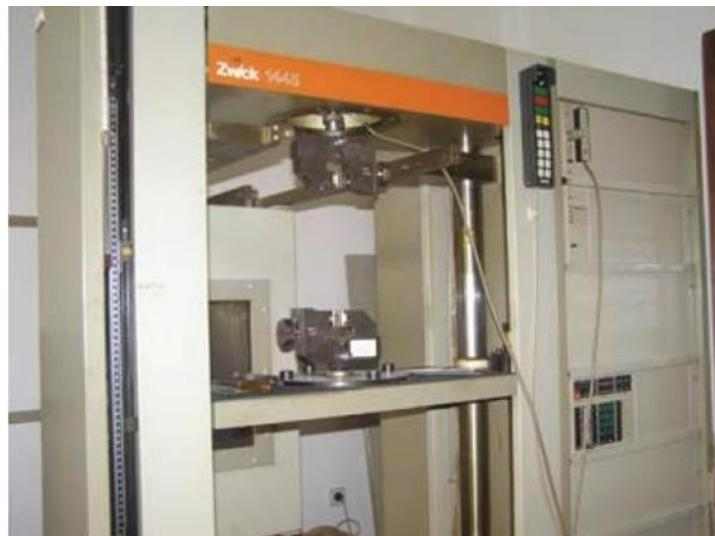
**Slika 46.** Univerzalna mehanička kidalica ZWICK 1445
