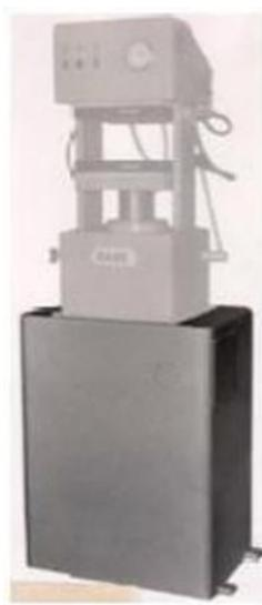
**Slika 45.** Hidraulička Dake preša.
