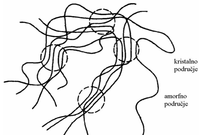
Slika 16. Model kristalastog polimera prema teoriji resastih micela
