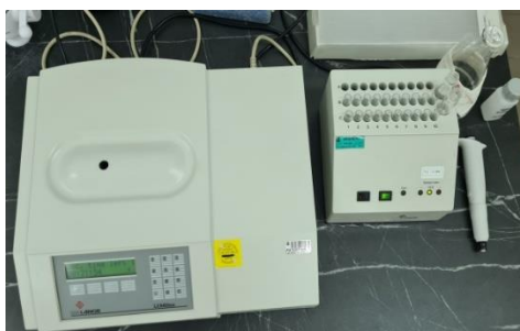
Slika 3.6. Luminometar LUMISTox 300 i termometar LUMISTherm, Hach-Lange GmbH.
