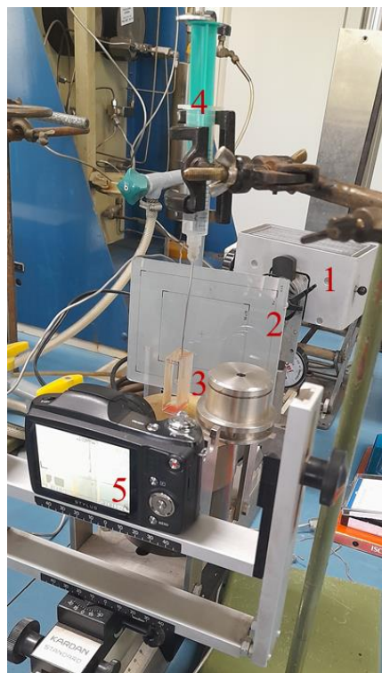
Slika 18. Aparatura za mjerenje kontaktnog kuta i međupovršinske napetosti. 1 - izvor svjetla 2 - raspršivač svjetla, 3 - kvarcna kiveta 4 - šprica s kapilaram 5 - fotoapararat
