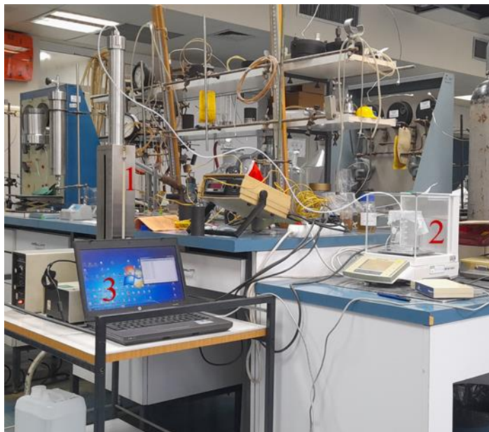
Slika 19. Aparatura za umjeravanje klipnih pumpi. 1 - klipna pumpa 2 - vaga s akvizicijskom karticom za prikupljanje podataka 3 - računalo
