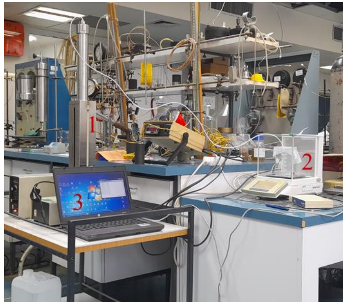
Slika 19. Aparatura za umjeravanje klipnih pumpi. 1 - klipna pumpa 2 - vaga s akvizicijskom karticom za prikupljanje podataka 3 - računalo
