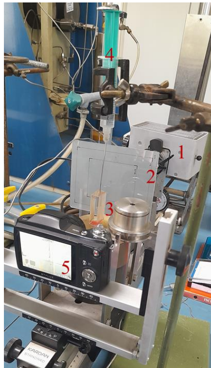
Slika 18. Aparatura za mjerenje kontaktnog kuta i međupovršinske napetosti. 1 - izvor svjetla 2 - raspršivač svjetla, 3 - kvarcna kiveta 4 - šprica s kapilaram 5 - fotoaparat
