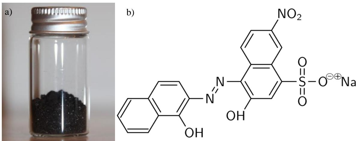
**Slika 2.** a) Fotografija crnog praha EBT-a i b) shema kemijske strukture EBT-a<sup>7</sup>
