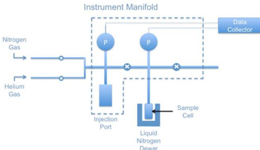
**Slika 8.** Shematski prikaz BET analizatora bez uključenog koraka otplinjavanja<sup>53</sup>
