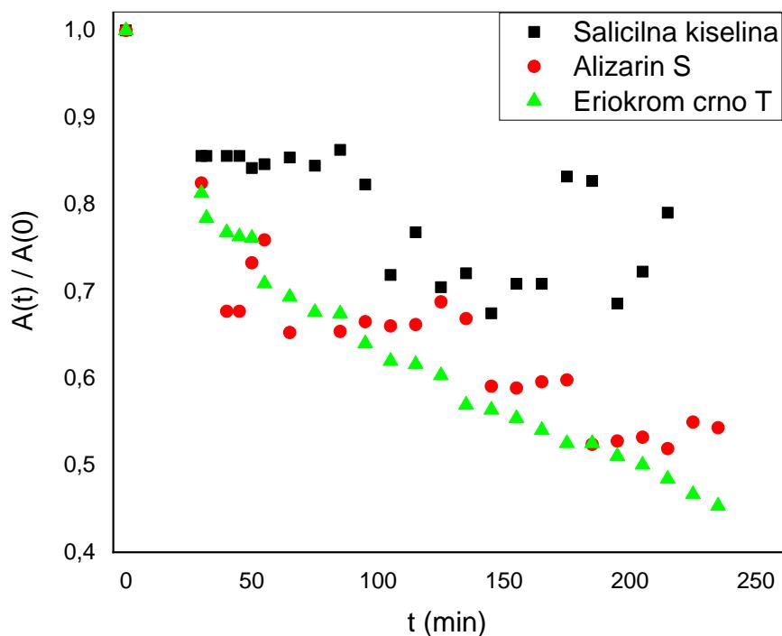
**Slika 15.** Degradacija raznih organskih zagađivača (salicilna kiselina, alizarin S i eriokrom crno T) sa fotokatalizatorom 10Cu:CeO<sub>2</sub>
