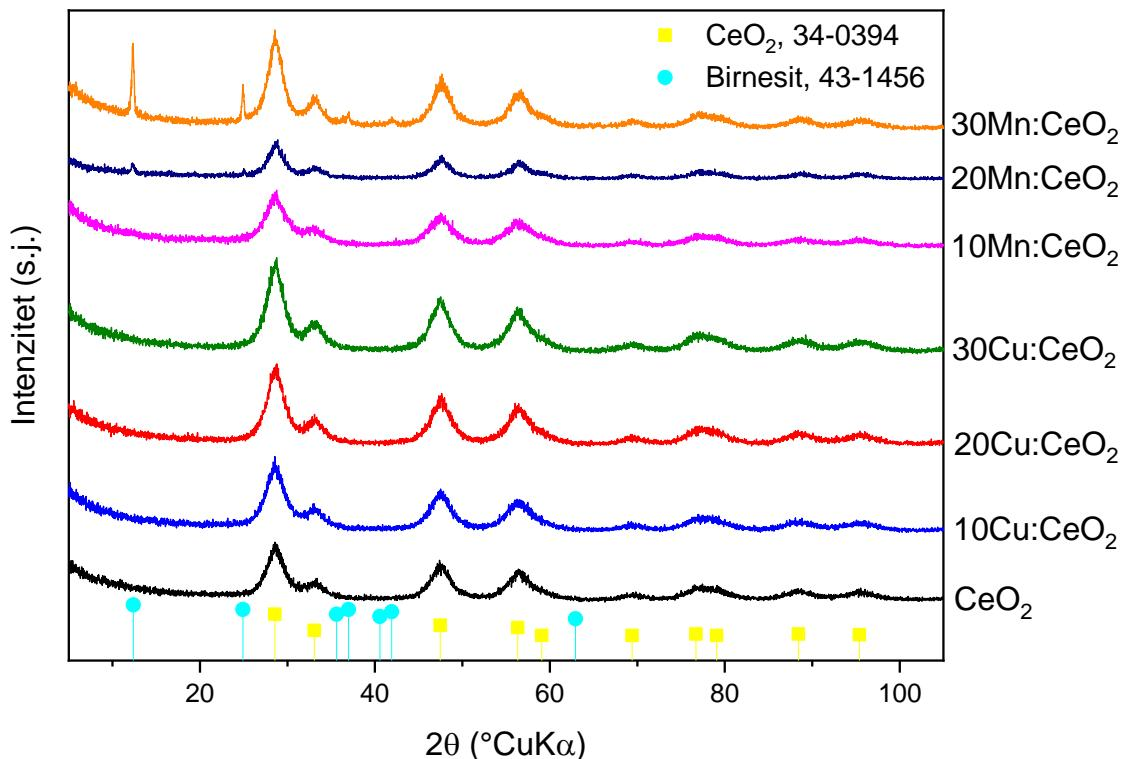
**Slika 11.** Difraktogrami čistog CeO<sub>2</sub> i uzoraka dopiranih sa manganom i bakrom
