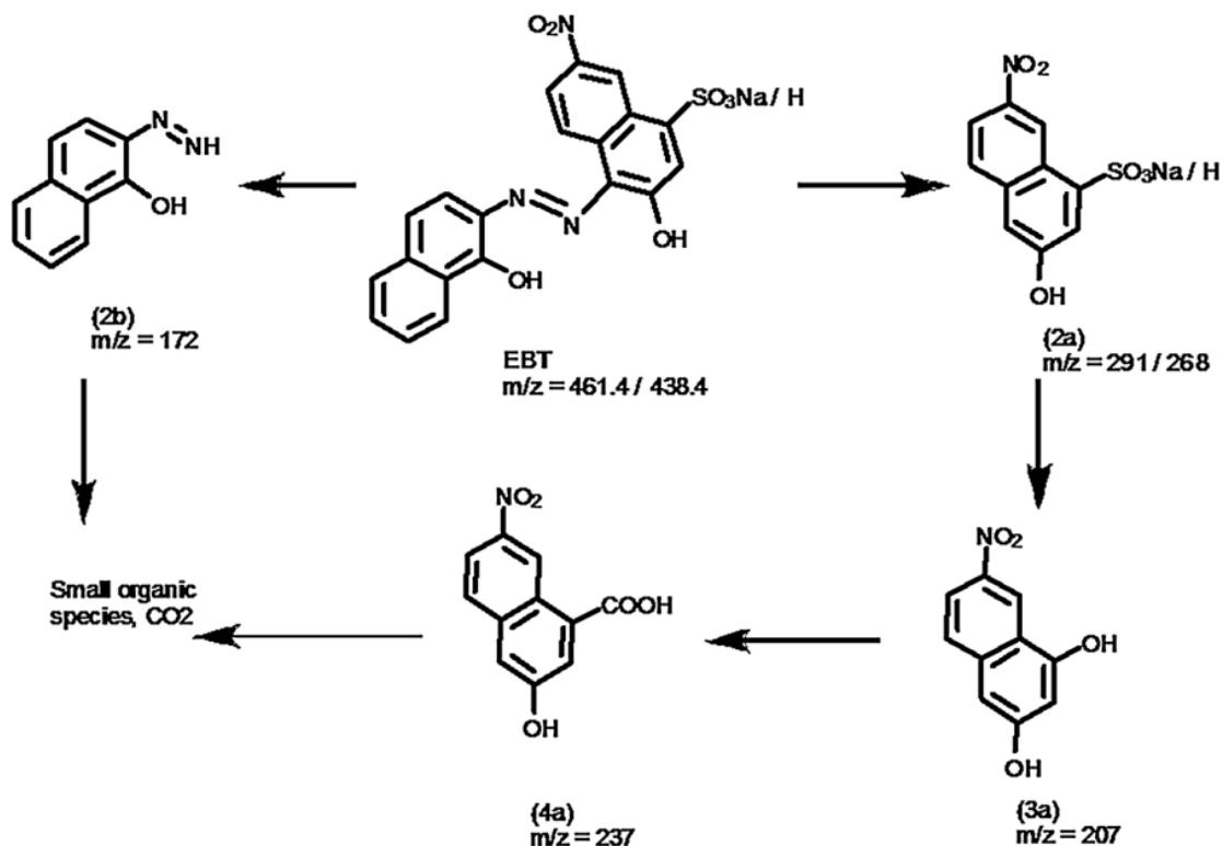
Slika 4. Fotokatalitički degradacijski put EBT-a<sup>7</sup>
