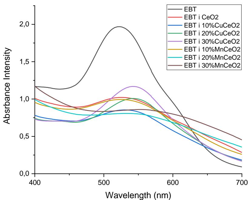
**Slika 16.** UV-Vis spektri za čisti EBT i za EBT uz fotokatalizator (svi ispitni uzorci CeO<sub>2</sub>) u 250. minuti fotokatalize
