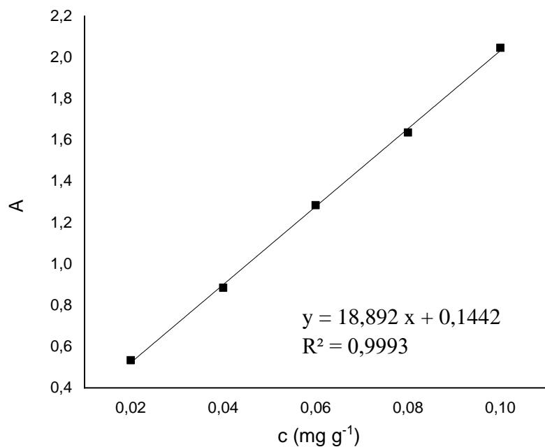
**Slika 17.** Baždarni dijagram eriokroma crno T u rasponu koncentracija od 0,02 do 0,1 mg g<sup>-1</sup> sa pripadajućom jednadžbom pravca i koeficijentom determinacije
