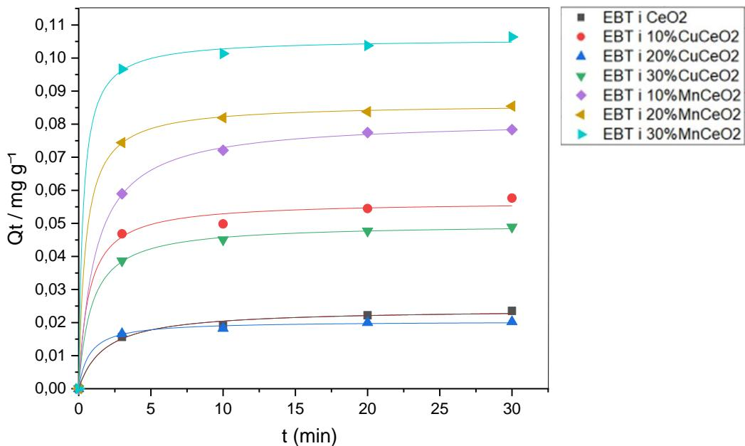
**Slika 20.** Učinak kontaktnog vremena na adsorpciju EBT-a za čisti i dopirani CeO<sub>2</sub> (eksperimentalne točke) i utočnjavanje na kinetički model pseudo-drugog reda (linije)
