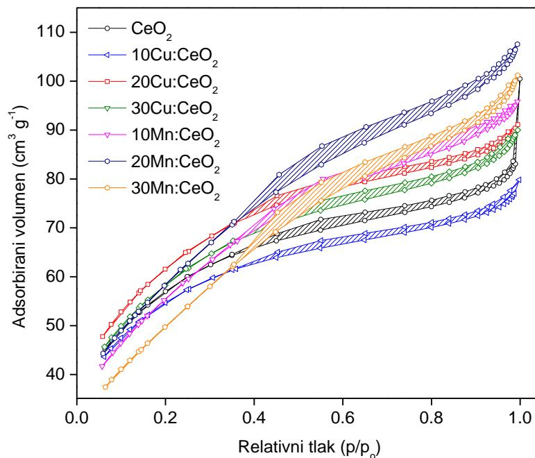
**Slika 13.** N<sub>2</sub> adsorpcijsko-desorpcijske izoterme za čisti CeO<sub>2</sub> i uzorke CeO<sub>2</sub> dopirane bakrom i manganom
