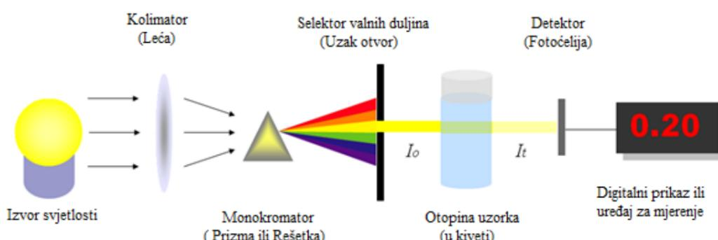
**Slika 9.** Osnovni dijelovi UV/VIS sprektofotometra<sup>52</sup>
