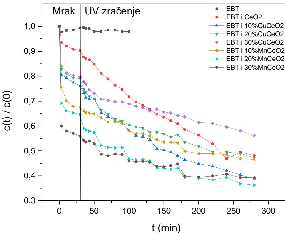
**Slika 18.** Degradacija EBT-a adsorpcijom i fotokatalizom bez upotrebe fotokatalizatora, sa čistim CeO<sub>2</sub> i dopiranim (Cu i Mn) uzorcima CeO<sub>2</sub> na valnoj duljini od 530 nm
