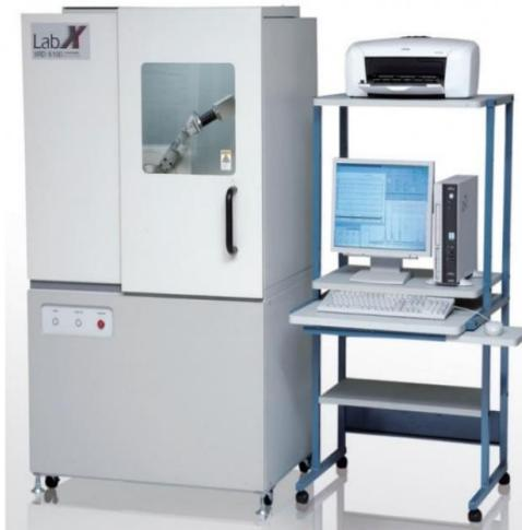
**Slika 7.** Rendgenski difraktometar Shimadzu XRD 6000<sup>51</sup>
