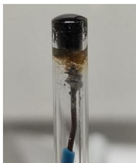
Slika 12. Elektroda odmah nakon nakapavanja disperzije MWCNT
