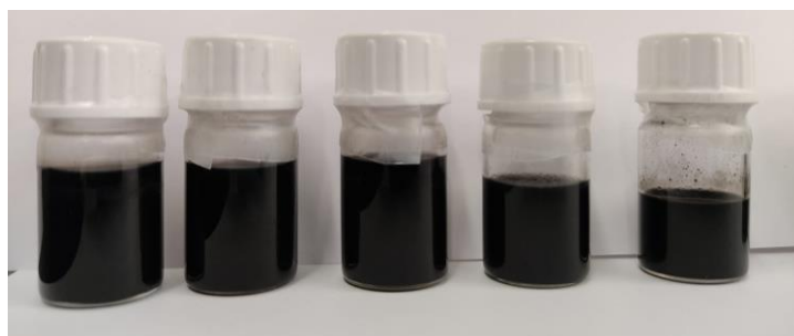
Slika 14. Prva serija disperzija MWCNT (redom 1, 2, 3, 4.2, 4) tjedan dana nakon pripreme, tri dana nakon ultrazvučne homogenizacije od 2 h
