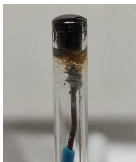
Slika 12. Elektroda odmah nakon nakapavanja disperzije MWCNT
