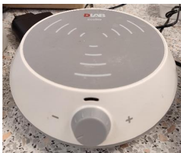
Slika 3.6. Magnetska miješalica EcoStir DLab
