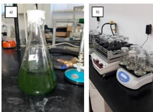
Slika 12. a) Fotografski snimak uzgojene mikroalge Scenedesmus sp. i b) određivanja toksičnosti MP-PE primjenom mikroalge Scenedesmus sp.
