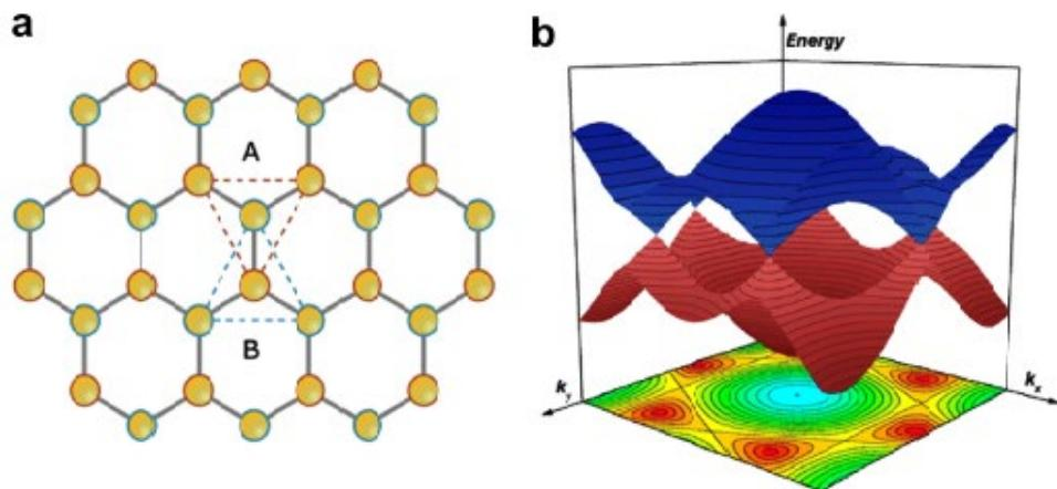
**Slika 21.** (a) Atomska struktura grafena. (b)  $\pi-\pi^*$  struktura grafena. Prva Brillouinova zona prikazana je crvenom i plavom bojom za valentnu i vodljivu  $\pi$  vrpcu<sup>4</sup>.
