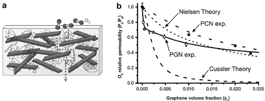
**Slika 69.** a) Prikaz nastajanja zavojitog puta. b) Mjerenje propusnosti kisika za CMG/PS nanokompozit i montmorilonit / PS nanokompozit kao funkcije udjela punila uspoređeno s dvije teorije propusnosti <sup>22</sup>.
