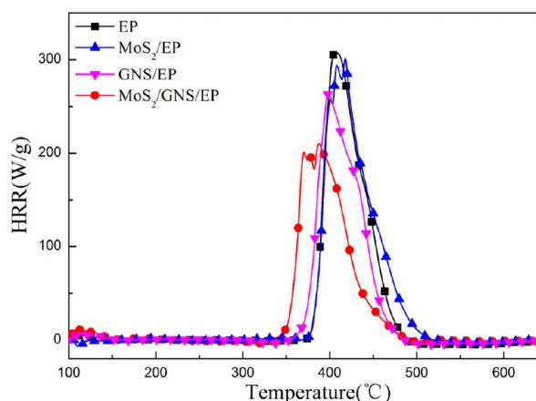
**Slika 67.** Krivulje brzine oslobođanja topline čistog epoksida, sustava grafenske nanočestice/epoksid, sustava  $\text{MoS}_2/\text{epoksid}$  i sustava  $\text{MoS}_2/\text{grafenske nanočestice/epoksid}$ <sup>17</sup>.
