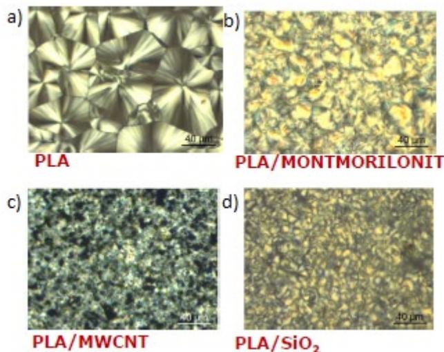
*Slika 37.* Smanjenje sferolita dodatkom različitih nanopunila. a) Čisti polimer. b) Dodatak montmorilonita. c) Dodatak nanocijevčica s više stijenki. d) Dodatak SiO<sub>2</sub>.
