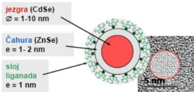
**Slika 16.** Kvantna točka strukture jezgra-čahura
