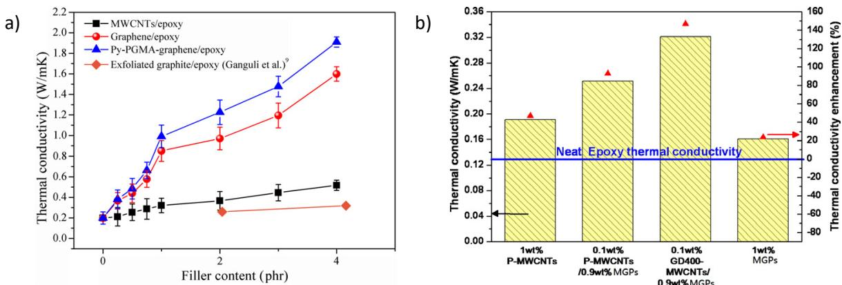
**Slika 64.** a) Toplinska vodljivost s različitim punilima; MWCNT/epoksid, grafen/epoksid, poli(glicidilmetakrilat) (Py-PGMA-grafen). b) Toplinska vodljivost epoksidnih kompozita s 1% masenog udjela nemodificiranih ugljikovih nanocjevčica s više stjenki (p-MWCNT), 0,1 % masenog udjela p-MWCNT / 0,9 % masenog udjela višeslojnog grafena (MGP), 0,1 % masenog udjela GD400-MWCNT/0,9 % masenog udjela MGP i 1 % masenog udjela MGP<sup>18</sup>.
