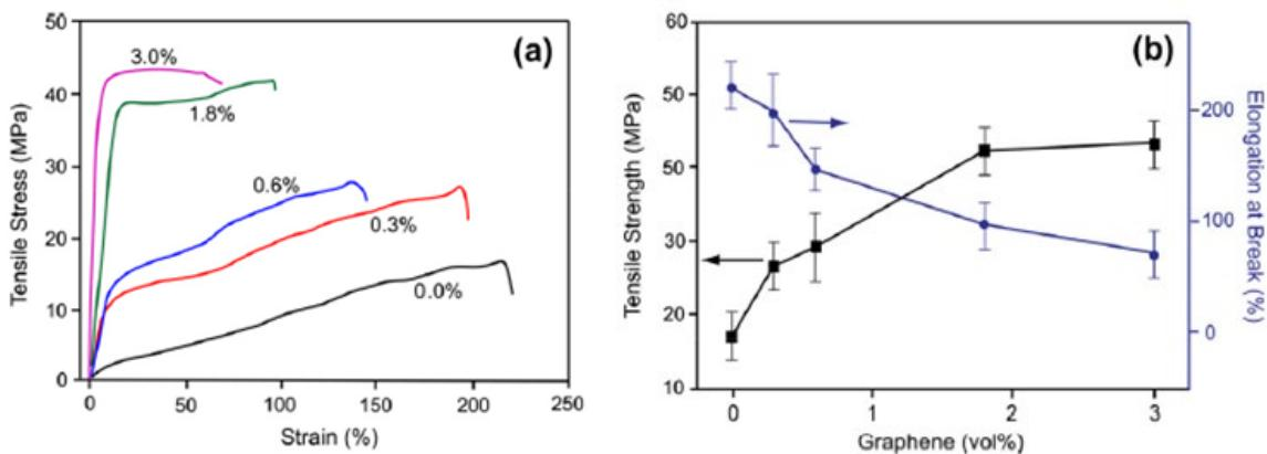
**Slika 58.** a) Ovisnost naprezanje-deformacija za nanokompozite s različitim volumnim udjelom grafena. b) Ovisnost vlačne čvrstoće i prekidnog produljenja o volumnom udjelu grafena<sup>19</sup>.
