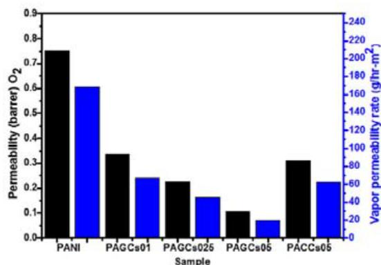
**Slika 70.** Propusnost čistog polianilina te ojačanog polianilina <sup>18</sup>.
