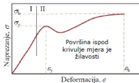
*Slika 38.* Tipična krivulja naprezanje – deformacija za termoplastične materijale.
