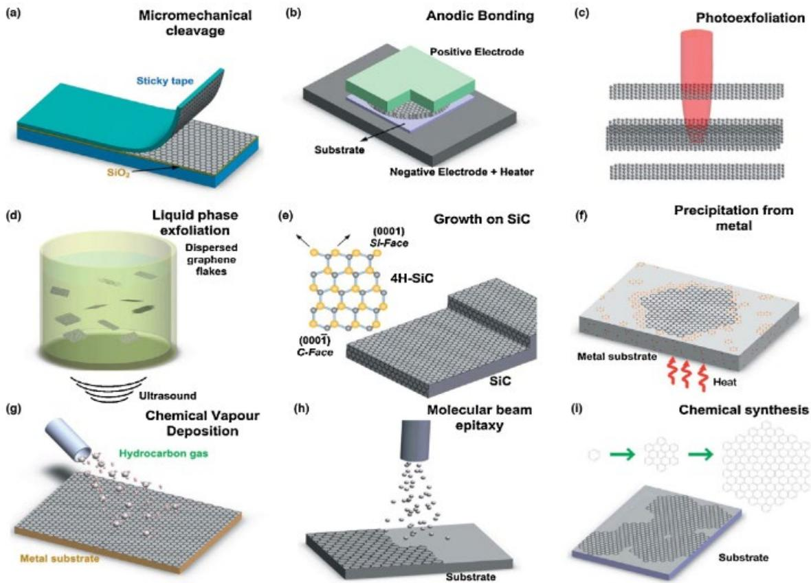
**Slika 23.** Prikaz najčešćih metoda za dobijanje grafena. (a) Mikromehanički rascjep. (b) Anodno vezanje. (c) Fotoeksfolijacija. (d) Raslojavanje u tekućoj fazi. (e) Rast na SiC. (f) Taloženje iz metala. (g) Kemijska depozicija pare. (h) Epitaksija molekulnih zraka. (i) Kemijska sinteza<sup>8</sup>.
