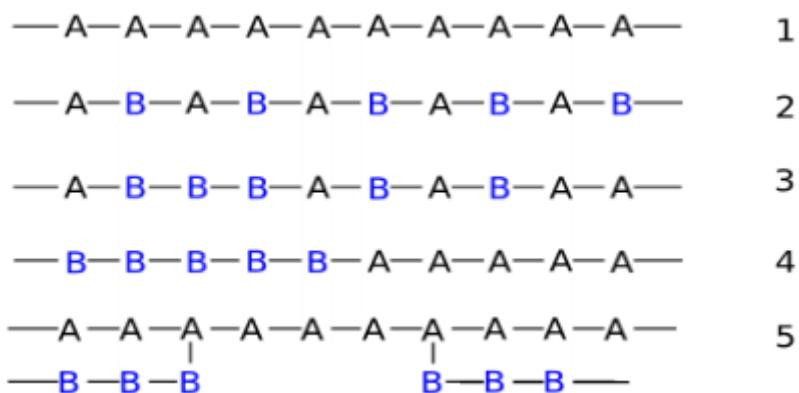
**Slika 1.** Shematski prikaz homopolimera (1) i kopolimera: 2-alternirajući, 3-statistički, 4-blok-kopolimer, 5- cijepljeni kopolimer<sup>1</sup>.
