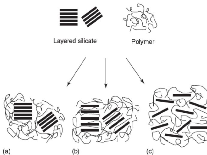
**Slika 35.** Vrste polimernih mikrostruktura. (a) neinterkalirana (mikrokompoziti). (b) Interkalirana (nanokompoziti). (c) eksfolirana (nanokompoziti)<sup>15</sup>.
