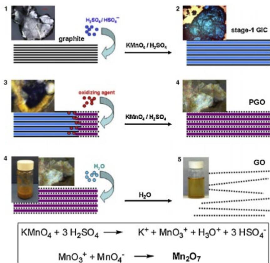
**Slika 24.** Hummerova metoda dobijanja grafen oksida opisana u tri koraka (Dimiev i Tour) (crne pune crte predstavljaju slojeve grafena, plave  $\text{H}_2\text{SO}_4/\text{HSO}_4$  interkalaciju, a ljubičaste kombinaciju  $\text{H}_2\text{SO}_4/\text{HSO}_4$  interkalacije i reduciranoj obliku okidacijske tvari)<sup>8</sup>.
