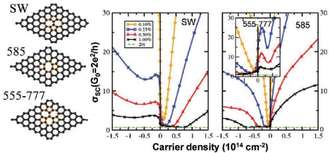
*Slika 60.* Ovisnost vodljivosti grafena o koncentraciji defekata u strukturi<sup>17</sup>.
