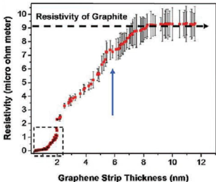
*Slika 59.* Ovisnost otpora grafena i debljine slojeva <sup>17</sup>.
