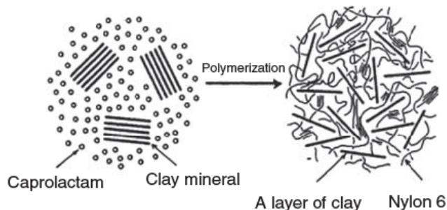
**Slika 34.** Sinteza najlon 6- glinenog kompozita *in situ* polimerizacijom<sup>12</sup>.
