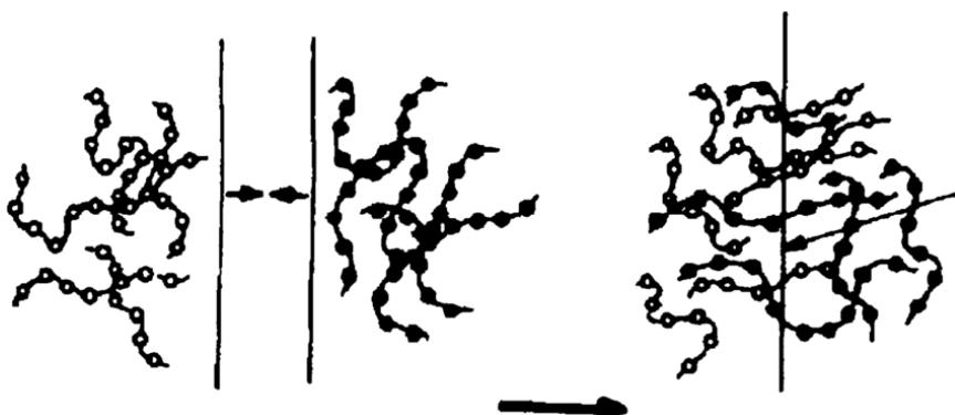
**Slika 29.** Modifikacija punila površine polimernim molekulama<sup>3</sup>
