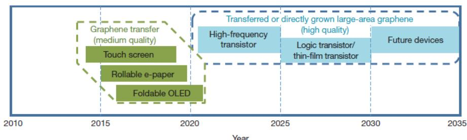
**Slika 26.** Zasloni i elektronički uređaji na bazi grafena. Upotreba grafena kod zaslona prikazana je zelenom bojom. Upotreba grafena kod elektroničkih uređaja prikazana je plavom bojom<sup>5</sup>.
