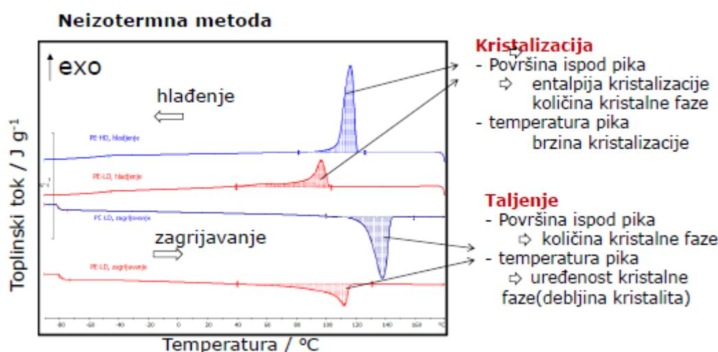
*Slika 36.* Ovisnost toplinskog toka o temperaturi za polietilen visoke čvrstoće.
