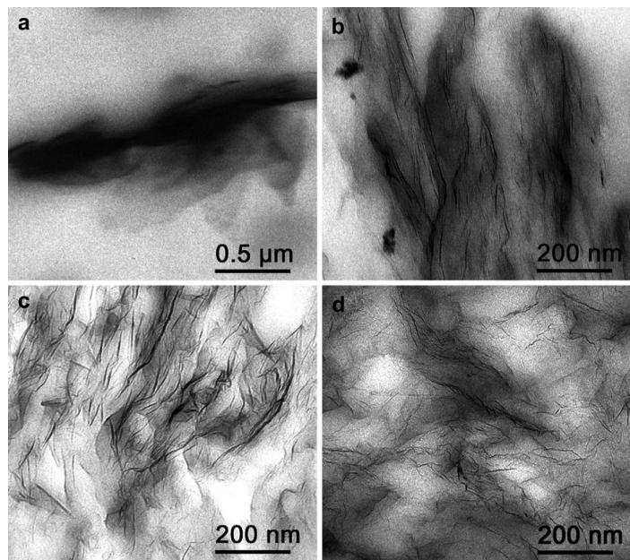
**Slika 71.** Ilustracija razlika u morfologiji poliuretana dobivena TEM-om pomiješanim s: a) grafitom b) toplinski eksfoliranim grafen oksidom (TEGO) – kompozit dobiven miješanjem u talini polimera. c) TEGO – kompozit dobiven miješanjem u otopini polimera. d) TEGO – kompozit dobiven *in situ* polimerizacijom<sup>22</sup>.
