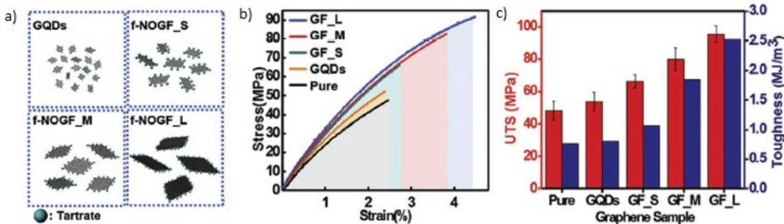
**Slika 56.** a) Shematski prikaz neoksidiranog grafena različite veličine. b) Krivulja naprezanja-deformacija za nanokopozite grafen/epoksid. c) Čvrstoća i žilavost grafen/epoksid nanokompozita ovisno o većini grafena<sup>17</sup>
