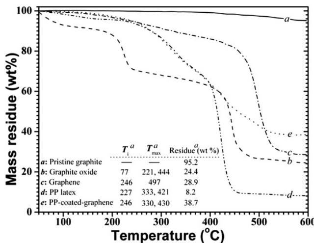
**Slika 66.** TGA krivulja grafita, oksidiranog grafita, grafena, PP lateksa i grafena prekrivenog PP lateksom.  $T_5^a$  označava temperaturu pri kojoj se raspalo 5 % mase;  $T_{max}^a$  označava temperaturu pri kojoj dolazi do najvećeg gubitka mase. Zagrijavanje je provedeno do  $600\text{ }^{\circ}\text{C}$
