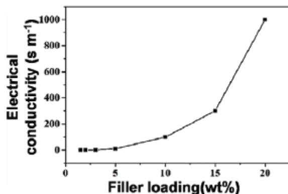
*Slika 62.* Ovisnost električne vodljivosti o koncentraciji punila u sustavu polimer na bazi vode/ sulfonirani grafen<sup>17</sup>.
