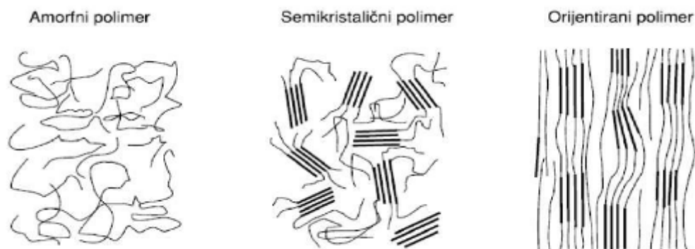
Slika 6. Podjela polimera s obzirom na nadmolekulsku strukturu.
