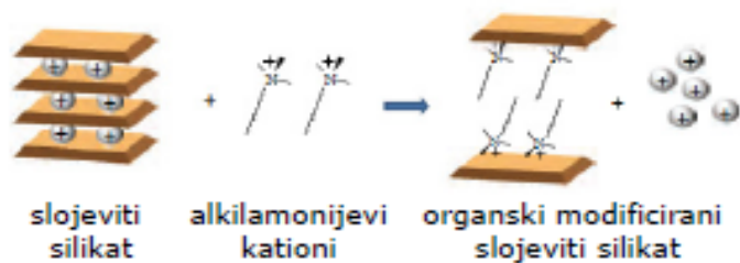
Slika 10. Organska modifikacija slojevitih punila
