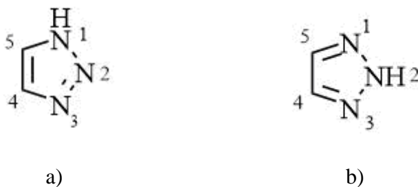
Slika 8. Tautomerni oblici a) 1H-1,2,3-triazola i b) 2H-1,2,3-triazola.
