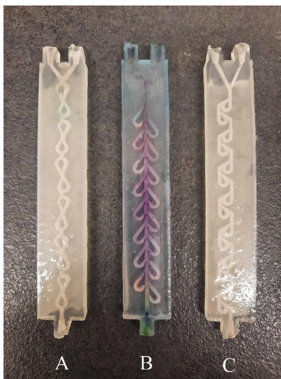
Slika 15. Prikaz ispisanih milireaktora: A) reaktor s Teslinim strukturama oblika "osmice", B) reaktor s jednostavnijim Teslinim strukturama, C) reaktor sa složenijim Teslinim strukturama
