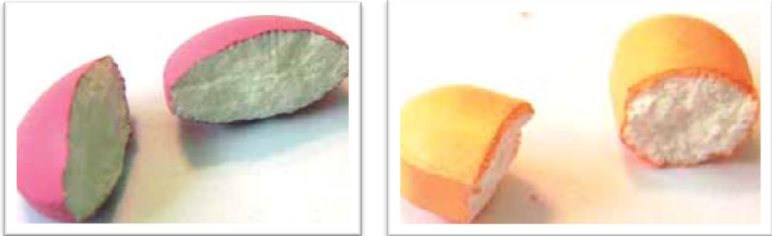
Slika 1. Presjek filmom obloženih tableta [8]
