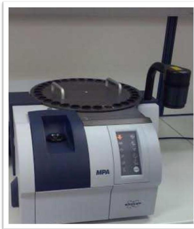
Slika 9. NIR spektrometar MPA 122000
