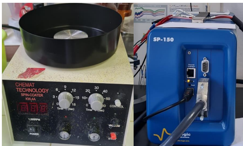
Slika 3.3. Spin-coater korišten za imobilizaciju fotokatalizatora na supstrat (lijevo); potencijostat (desno)
