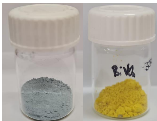
Slika 3.6. \text{WO}_3 prah (lijevo); \text{BiVO}_4 prah (desno)
