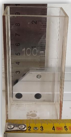
Slika 33: Prikaz mjerne ćelije sa zadanim dimenzijama
