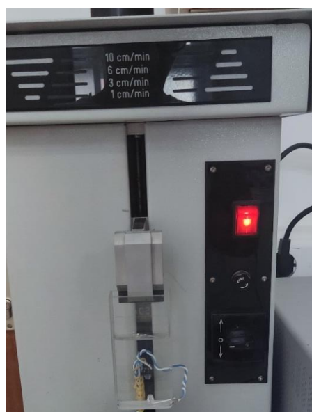
Slika 39: Mjerna ćelija prikvačena na uređaj za izradu tankih filmova
