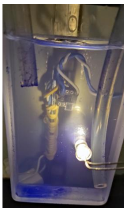
Slika 62: Mjerna ćelija kod koje se u donjem lijevom kutu dogodila nepoželjna sedimentacija, koja je također prikazana na grafičkom prikazu, (Slika 60). Desna cijev izlazi iz pumpe, a lijeva cijev je dozira, tj. povrat suspenzije u pumpu.
