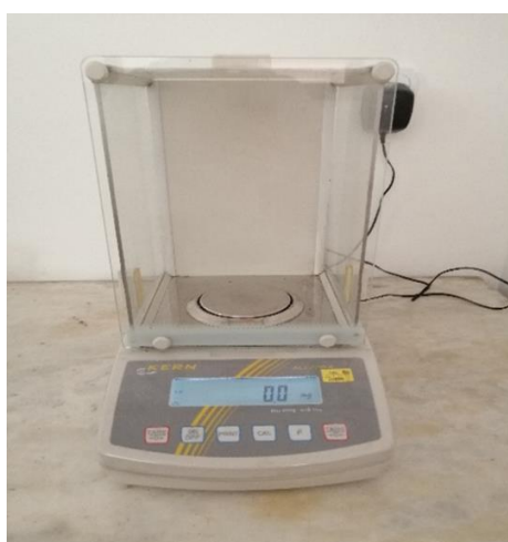
Slika 47: Analitička vaga KERN 220-04
