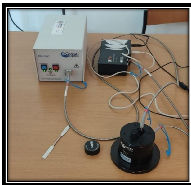
Slika 27 : DRS uređaj (Ocean Optics)
