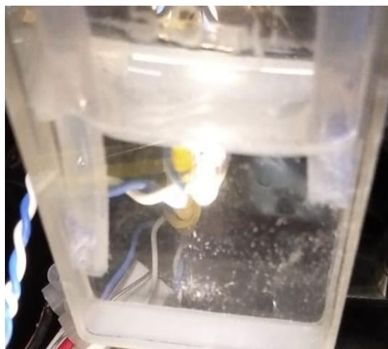
Slika 66: Sedimentirani talog \text{Al}(\text{OH})_3
