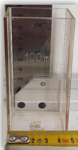
Slika 33: Prikaz mjerne ćelije sa zadanim dimenzijama
