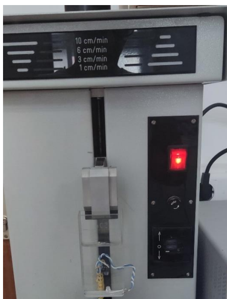
Slika 39: Mjerna ćelija prikvačena na uređaj za izradu tankih filmova
