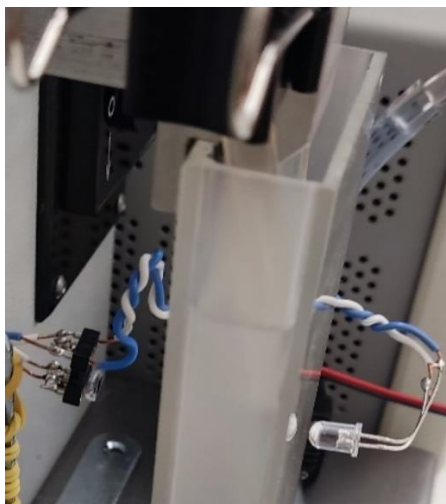
Slika 38: Izvor svjetlosti i fotodetektor postavljeni u fiksnu geometriju
