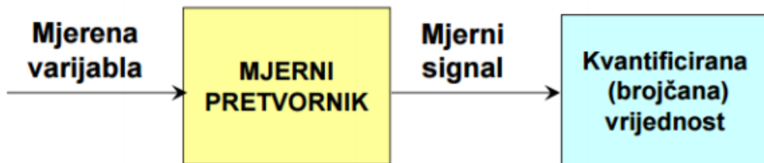
Slika 2-1. Shema rada mjernog pretvornika
