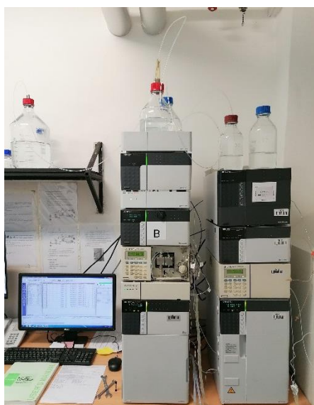
Slika 12. HPLC uređaj s UV detektorom proizvođača Shimadzu
