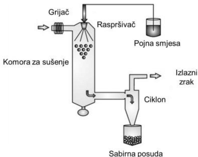
**Slika 3.4.** Shematski prikaz sušenja raspršivanjem.<sup>12</sup>
