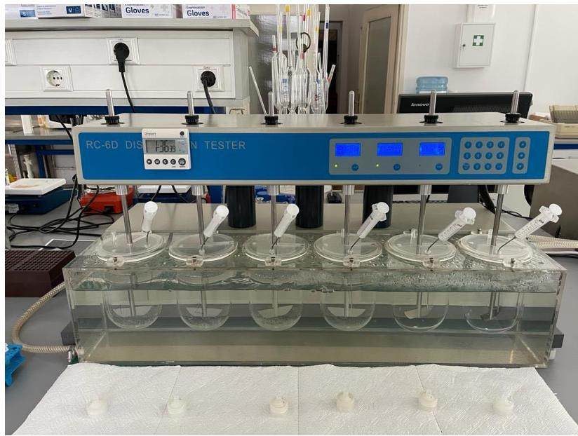
**Slika 4.16.** Fotografija uređaja za određivanje profila oslobođanja djelatne tvari RC-6D (Zhengzhou Nanbei Instruments, Zhengzhou, NR Kina).
