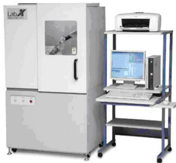
Slika 4.12. Fotografija uređaja za rendgensku difrakcijsku analizu praha XRD-6000 (Shimadzu, Kyoto, Japan).
