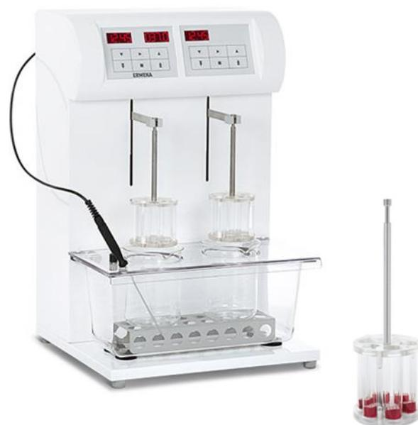
**Slika 4.14.** Fotografija uređaja za ispitivanje raspadljivosti tableta ZT 322
