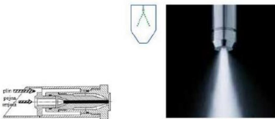
**Slika 3.5.** Dvofluidni raspršivač
