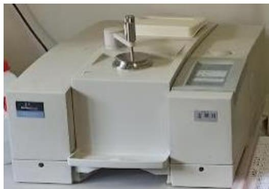
**Slika 4.11.** Fotografija infracrvenog spektrofotometra Perkin Elmer Spectrum ONE.
