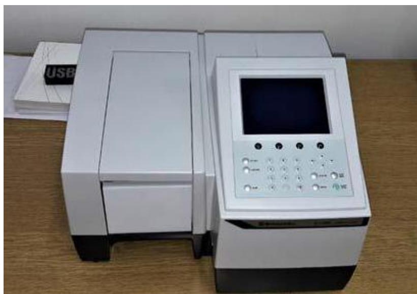
**Slika 4.15.** Fotografija spektrofotometra UV-1280 (Shimadzu, Kyoto, Japan).
