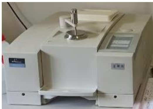
Slika 4.11. Fotografija infracrvenog spektrofotometra Perkin Elmer Spectrum ONE.
