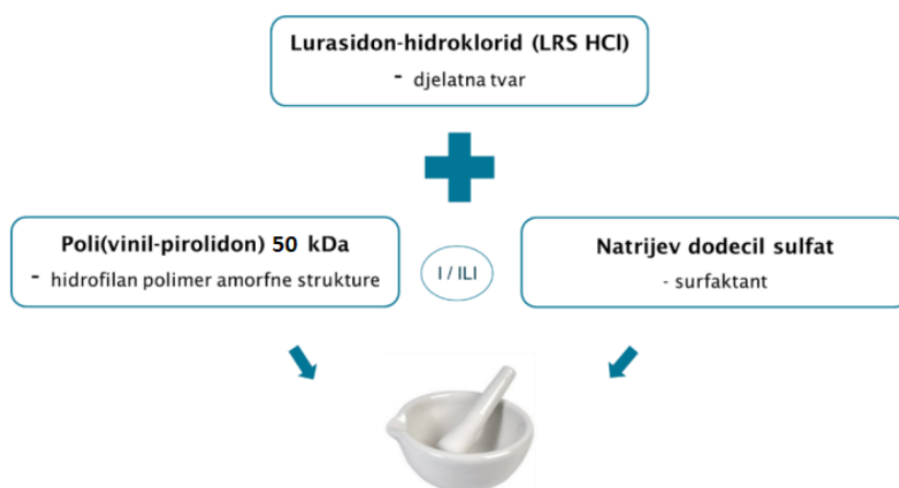
Slika 4.5. Priprava fizikalnih mješavina miješanjem u tarioniku s tučkom.
