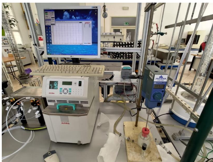
Slika 28. Aparatura za određivanje topljivosti
