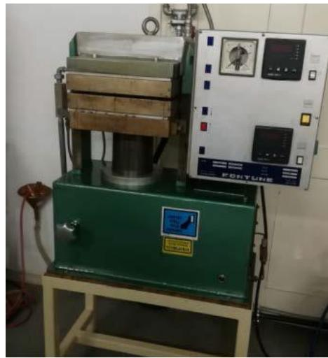
*Slika 17.* Hidrauliča preša Fontune, Holland
