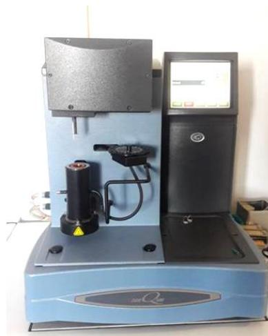
*Slika 18.* Termogravimetar Q500 tvrtke TA Instruments
