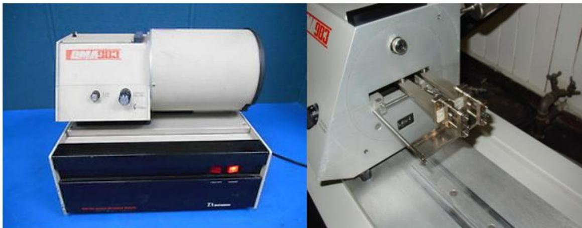
*Slika 19.* DMA analizator 983 tvrtke TA Instruments
