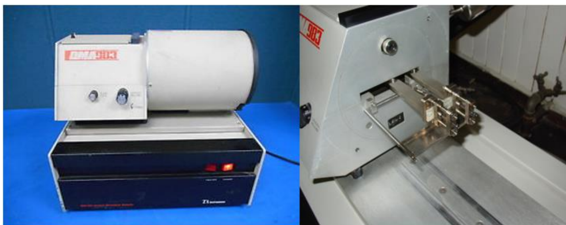
Slika 19. DMA analizator 983 tvrtke TA Instruments
