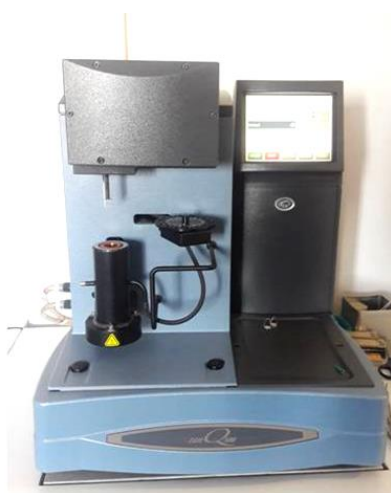
Slika 18. Termogravimetar Q500 tvrtke TA Instruments
