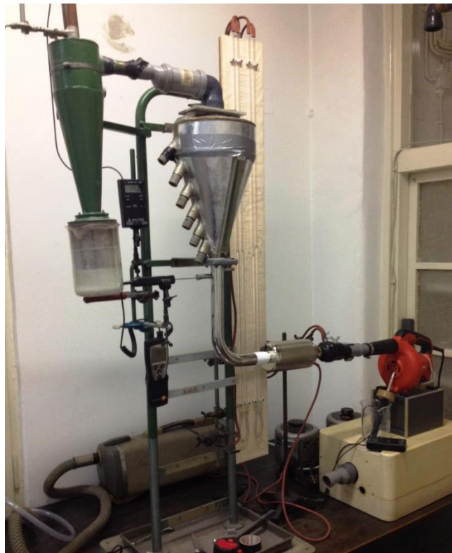
Slika 6. Laboratorijski sušionik s fluidiziranim slojem
